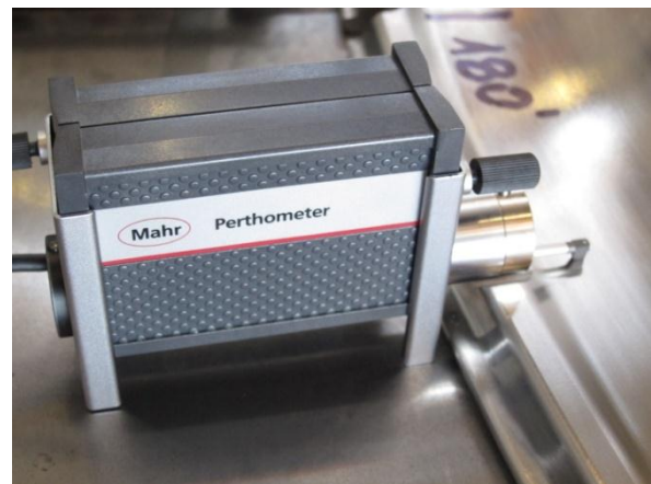
Figura 4.5 Rugosimetro Perthometer M1
