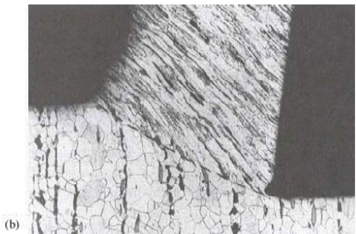
Figura 3.2 Visualizzazione dell'angolo di scorrimento: a) teoria schematizzata; b) micrografia durante lavorazione.
