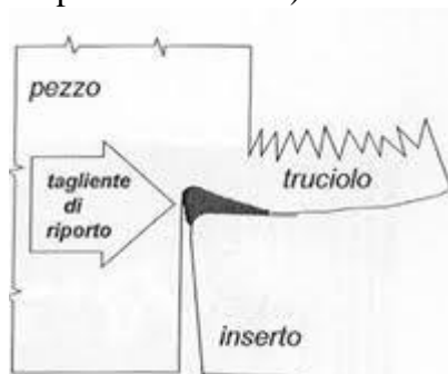
Figura 4.6 Formazione del tagliente di riporto nel petto dell'inserto.
