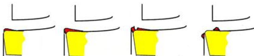
Figura 5.2 Formazione del tagliente di riporto: nascita, crescita e rottura.
