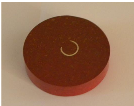
Figura 3.5 Provino con truciolo trasversale inglobato in resina fenolica rossa per presso-formatura.
