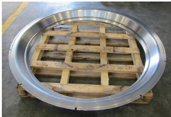
Figura 2.1 Anello in lega Nimonic 263 finito.
