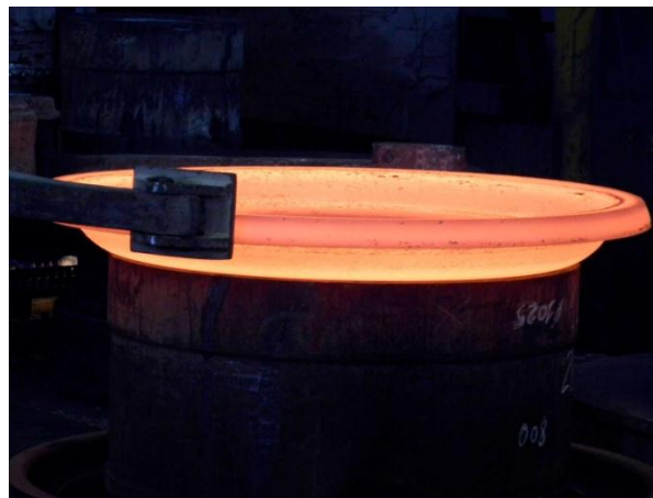
Figura 2.7 Anello deformato terminate le operazioni di forgia.
