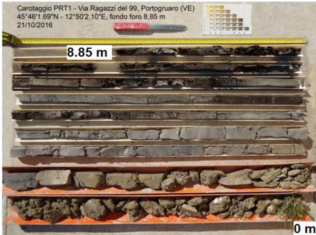
Figura 4.16 – Aspetto delle carote prelevate nel carotaggio PRT1 (per localizzazione del punto PRT1 vedi Figura 3.7).
