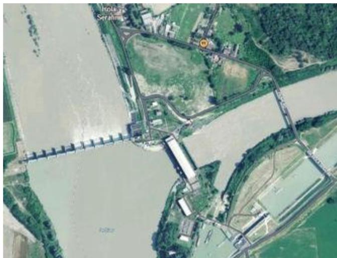
**Figura 18:** impianto di Isola Serafini, si noti in basso le canalizzazioni per deviare l'eccesso di portata e il coronamento a sfioro dello sbarramento
