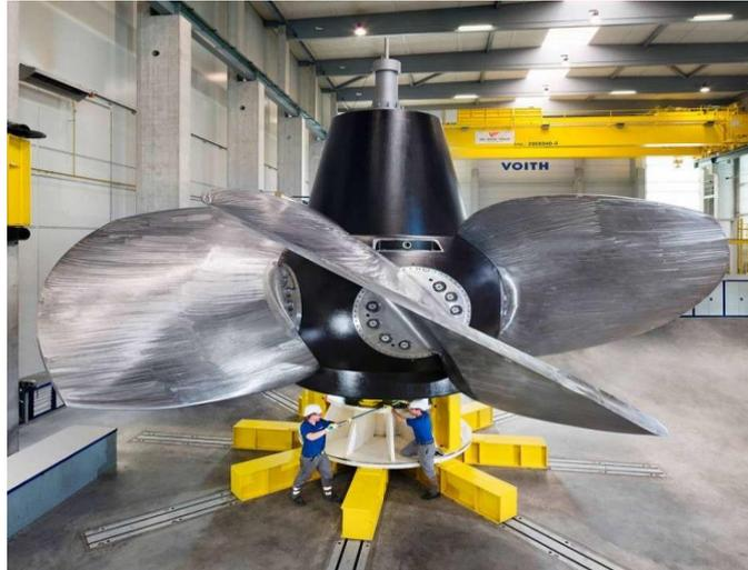
*Figura 9:* esempio di girante Kaplan di grandi dimensioni
