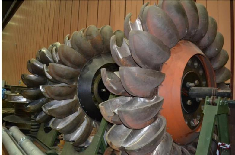
*Figura 5:* turbine Pelton della centrale di Roncovo Grande
