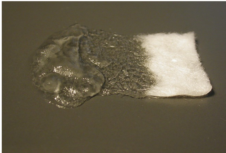
Fig. 2 Foglio di acido ialuronico ad un'estremità del quale è stata applicata dell'acqua.
