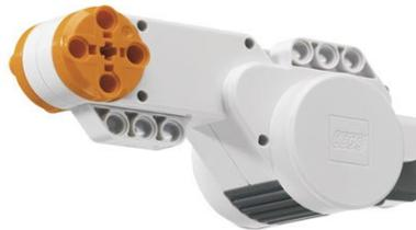
**Figura 2.2:** *Servomotore*
