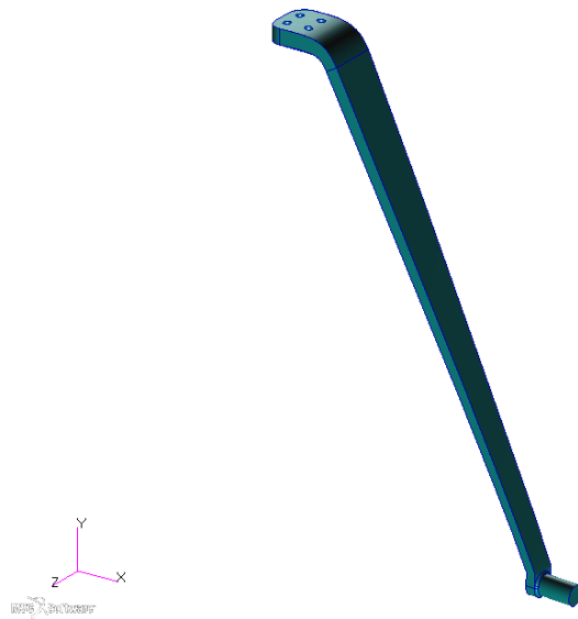
Figura 4.13: modello tridimensionale del carrello
