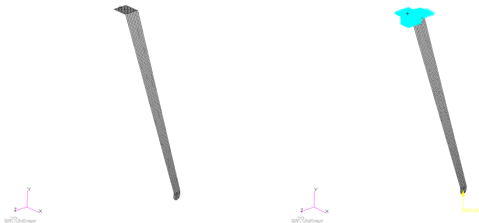
Figura 4.6: modello 2D del carrello d'atterraggio utilizzato per le simulazioni
