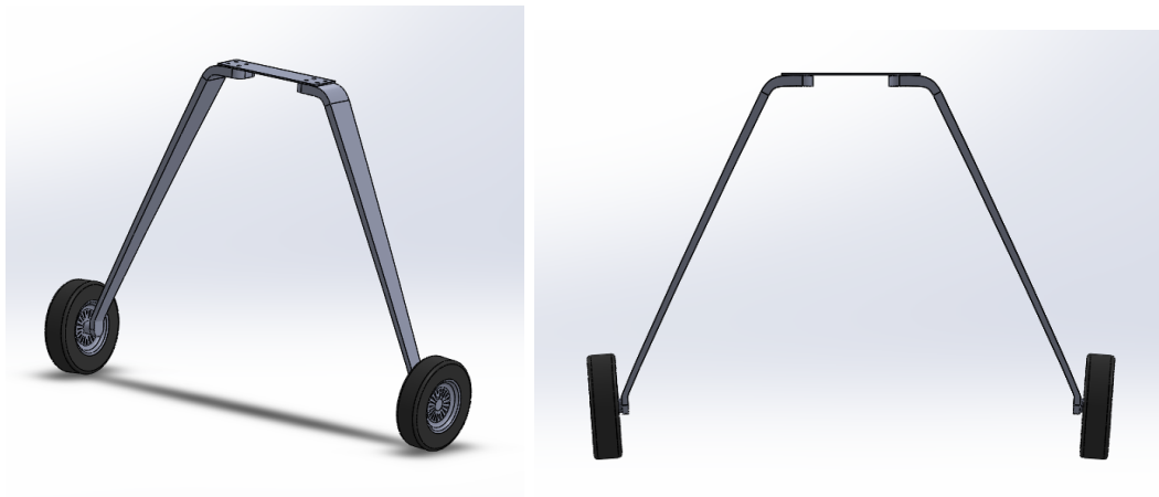
Figura 1.14: Disegno completo del carrello d'atterraggio
