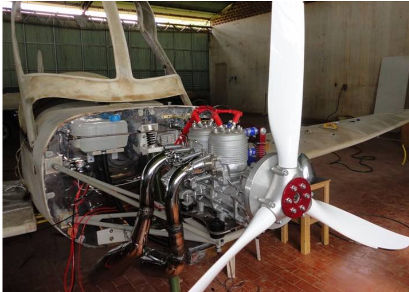
Figura 5.3: esempio di castello motore sul Simonini [8]
