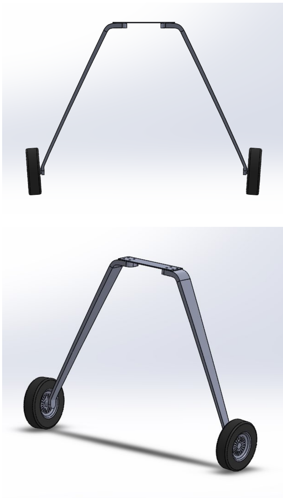
Figura 4.30: vista anteriore e isometrica dell'assieme carrello-ruota
