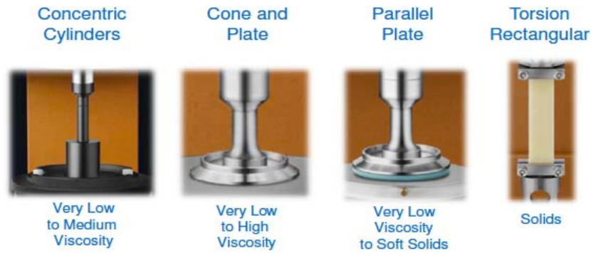
Figura 15 Rappresentazione delle diverse geometrie disponibili per un reometro rotazionale
