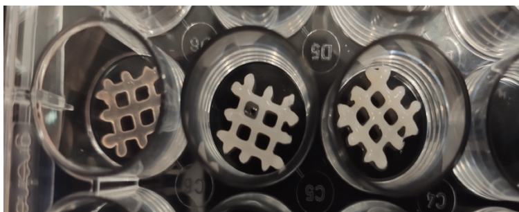
Figura 25 Scaffold di Alginato al 20% (w/v) a bassa viscosità cross-linkato rispettivamente con tempi di 1 min, 5 min, 10 min.
