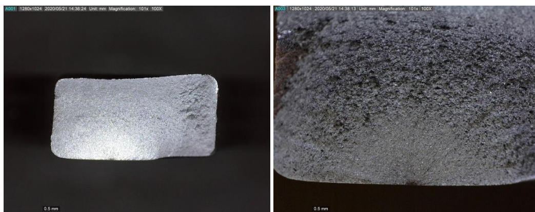
Figura 4.15. Test_22, a sinistra superficie di frattura (x20); a destra ingrandimento sulla zona di innesco (x100).
