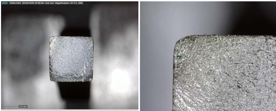
Figura 4.4. Test_13, a sinistra superficie di frattura (x20); a destra ingrandimento sulla zona di innesco (x100).
