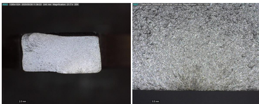
Figura 4.16. Test_24, a sinistra superficie di frattura (x20); a destra ingrandimento sulla zona di innesco (x100).
