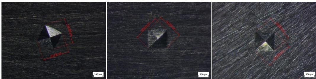
Figura 4.26. Impronta della prova di durezza su provino vergine.
