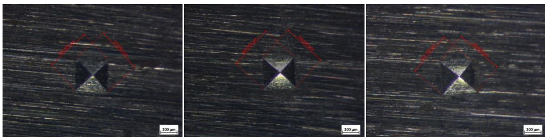
Figura 4.29. Impronta della prova di durezza su provino precedentemente testato a 280 MPa e che ha subito cedimento a 645516 cicli.
