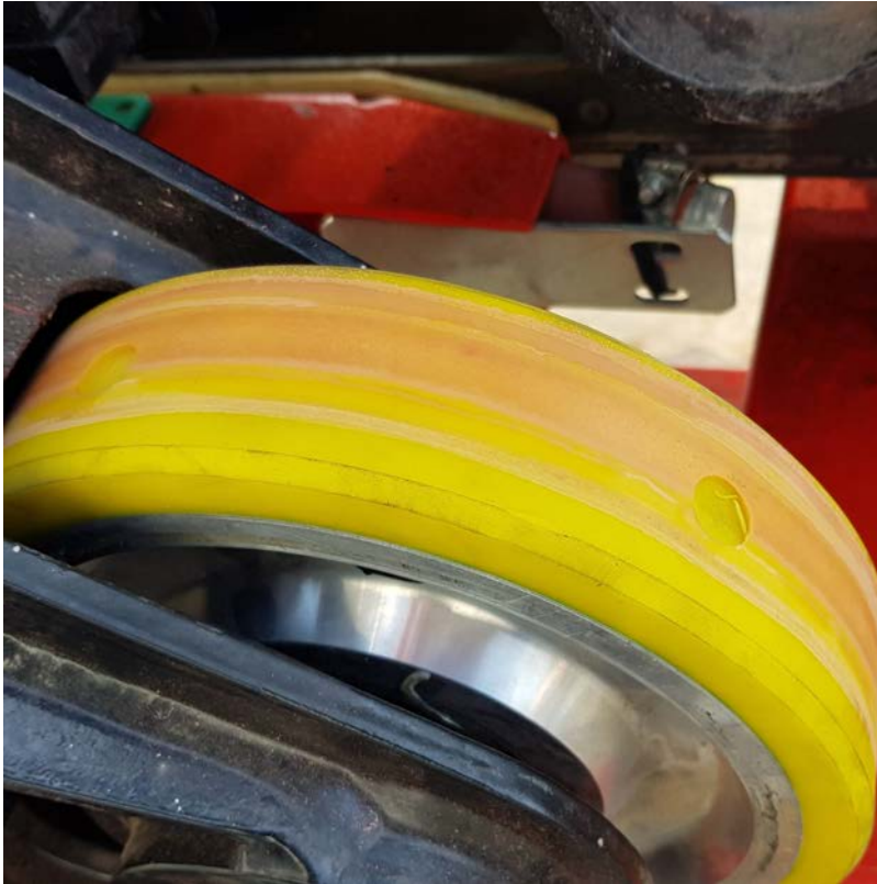
Figura 4.23: Ruota forata per la simulazione del caso di ruota rotta superficialmente
