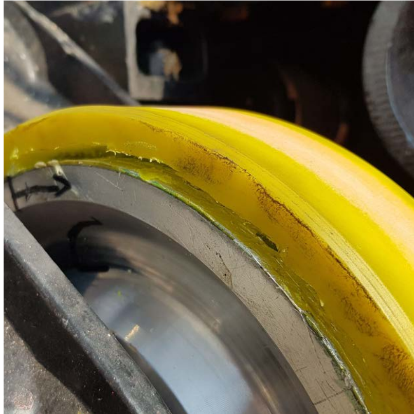
Figura 4.10: Ruota fresata per la simulazione del caso di ruota “scollata”
