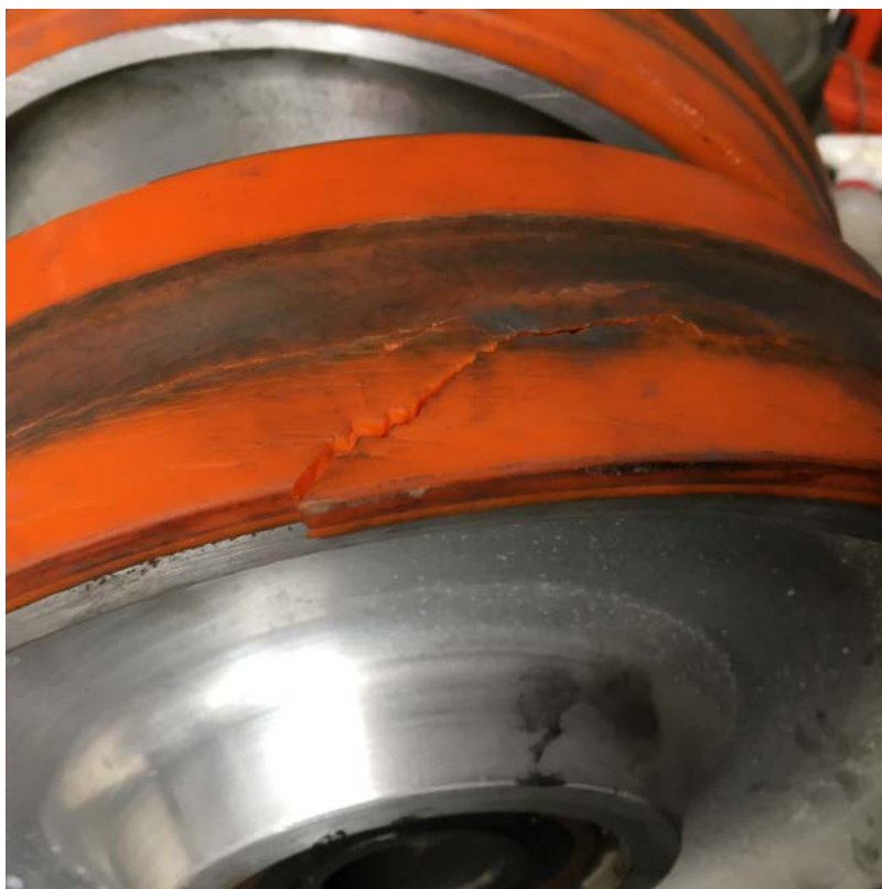
Figura 4.15: Esempio di ruota affetta da una rottura da cricca
