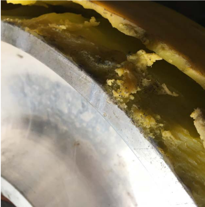
Figura 4.8: Esempio di ruota soggetta a "scollatura"
