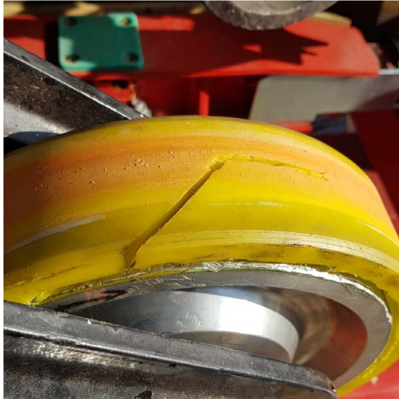
Figura 4.16: Ruota tagliata per la simulazione del caso di ruota rotta da cricca
