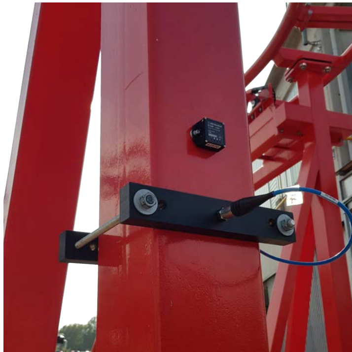
Figura 3.2: Sensori posizionati sulla colonna L3
