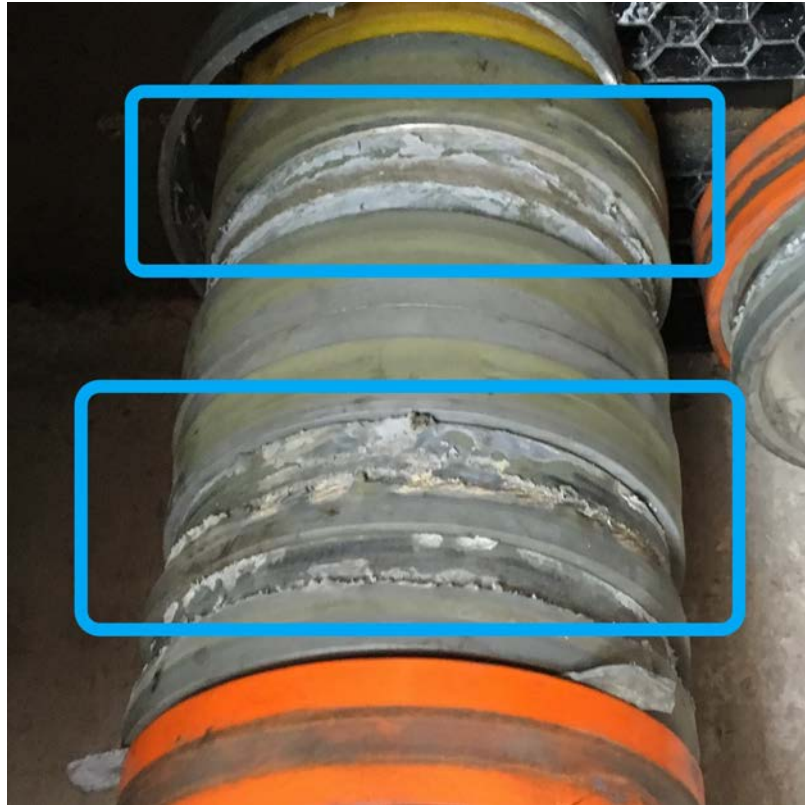
Figura 4.22: Esempio di ruota affetta da una rottura superficiale
