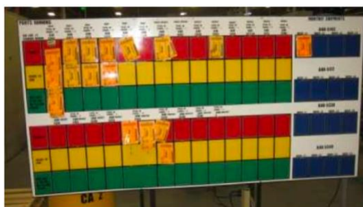
Figura 2.11 – Esempio di controllo visivo (Fomir, 2022)
