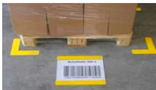
Figura 2.12 – Esempio di indicatore visivo (Fomir, 2022)
