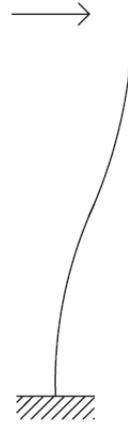
Figura 7.34: Schema deformata tagliante.
