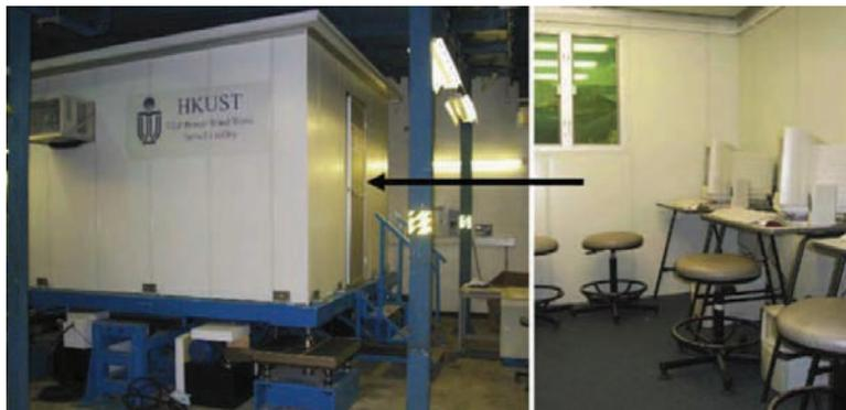
Figura 3.1: Simulatore di movimento a doppio asse e configurazione interna della camera test.
