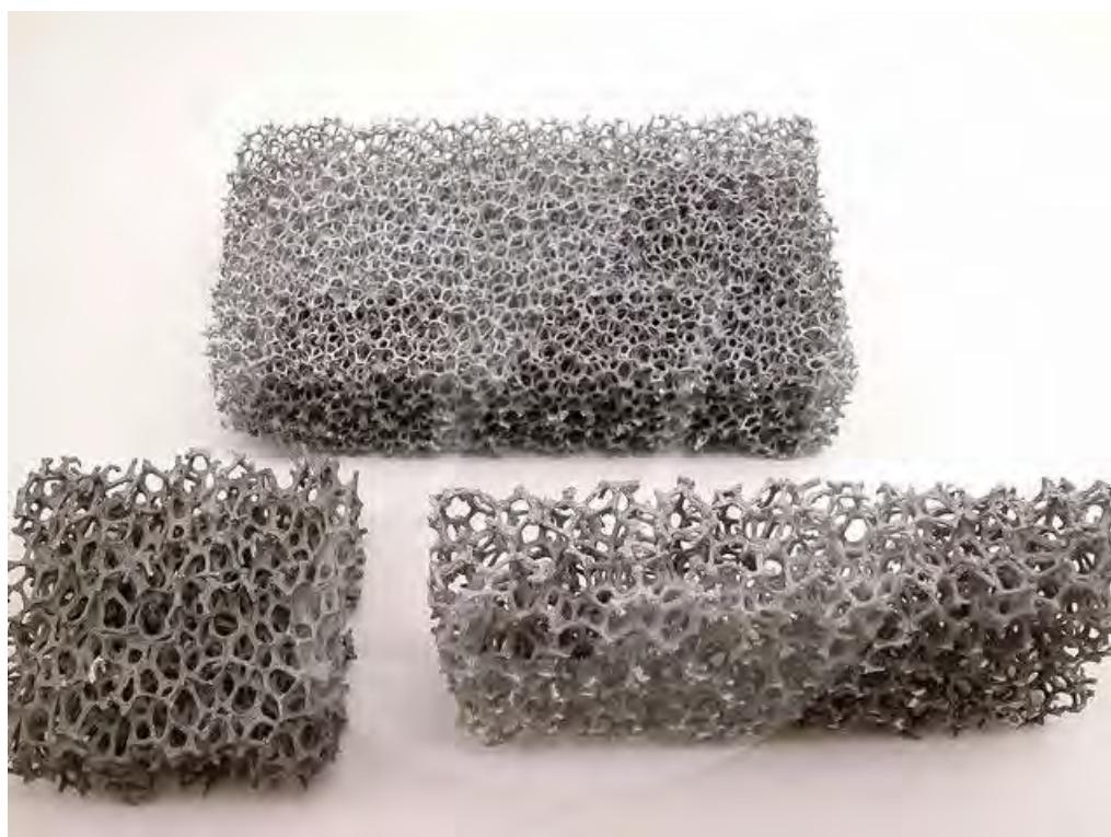
Figura 1.6: schiume metalliche a celle aperte. Fonte http://crsengine.com
