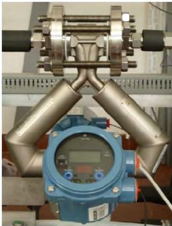
Figura 3.5: misuratore di portata massica ad effetto Coriolis. Fonte: foto scattata in laboratorio.
