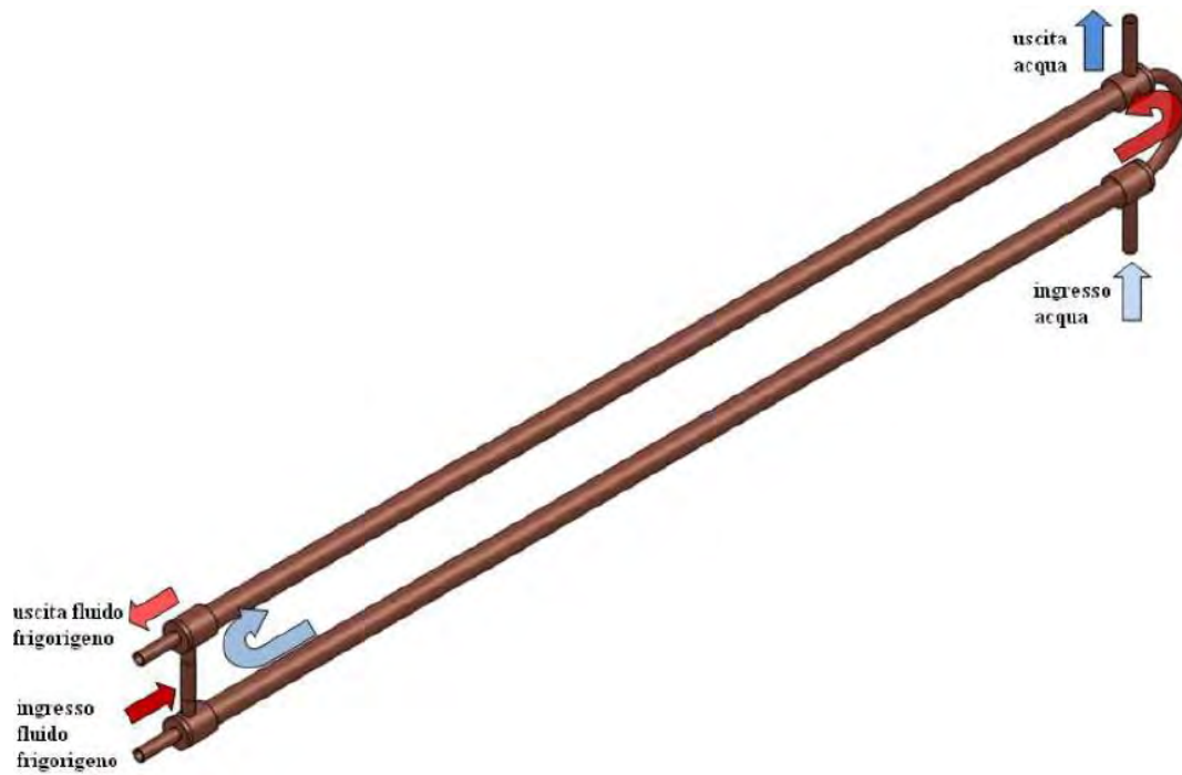
Figura 3.7: scambiatore di calore di tipo tubo in tubo. Fonte: Salvatore [4].
