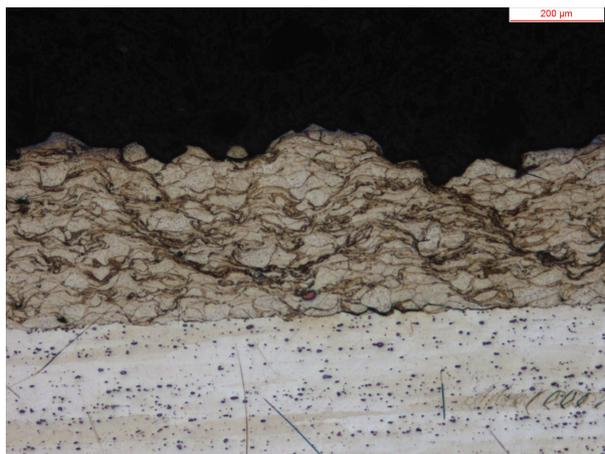
*Figura 3.41 : ingrandimento a 50X della superficie del coating del provino 6 trattata tramite attacco chimico.*
