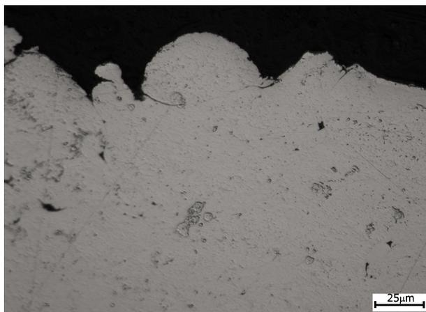
*Figura 3.15 : immagine a 500X relativa ad un coating realizzato ad una feed rate di 1,5 RPM. Si nota in primo piano una particella originariamente sferica, poco deformata e poco coesa al coating sottostante.*
