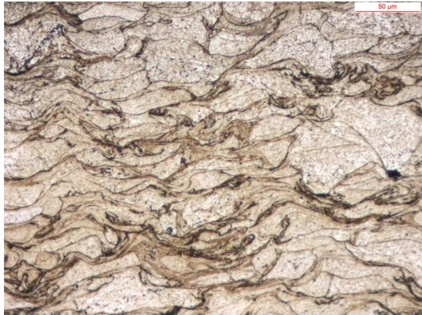
*Figura 3.42: ingrandimento a 200X della superficie del coating del provino 6 trattata tramite attacco chimico.*
