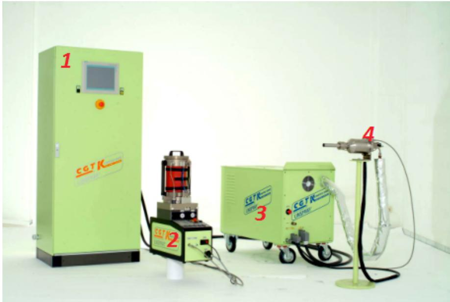
*Figura 3.1: impianto cold spray Kinetiks® 4000/47 presente nei laboratori Nanofab di Veneto Nanotech: 1) pannello di controllo; 2) feeder delle polveri; 3) preriscaldatore del gas; 4) pistola.*
