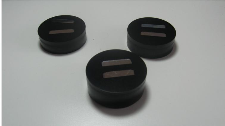
*Figura 3.10 : provini sezionati ed inglobati in cilindri di resina fenolica, lucidati e lappati.*
