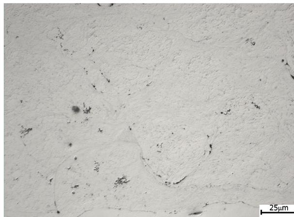
*Figura 3.20 : immagine con ingrandimento a 500X del coating di un provino realizzato tramite una feed rate di 0,5 RPM e polveri fredde.*
