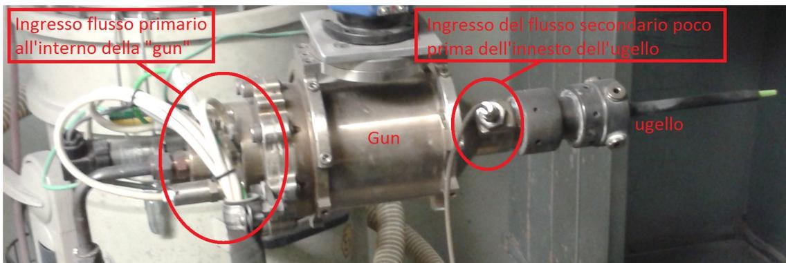
*Figura 3.2 : connessione delle condotte del flusso primario e secondario alla gun.*
