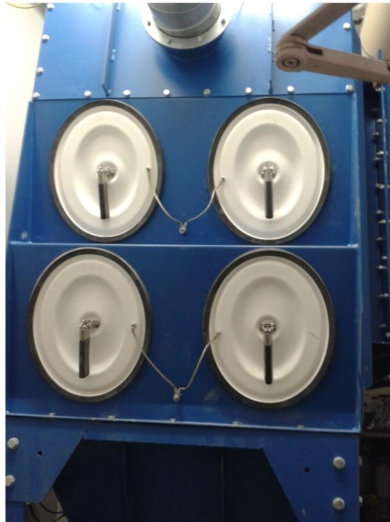
*Figura 3.5 : contenitore delle polveri aspirate dalla cappa.*
