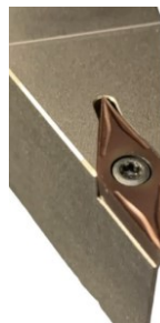
Figura 3.9: Inserto VCET 11 03 01 - UM 1115 utilizzato per la tornitura dei campioni di Nitinol montato nell'apposito porta inserti.
