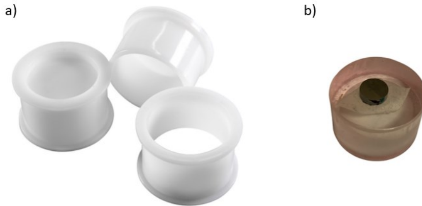
Figura 4.14: a) contenitori per iglobatura campioni; b) campione di Nitinol inglobato nella resina.
