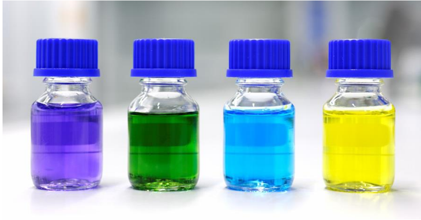
Fig 2.11 - Differenti stati di ossidazione del vanadio in soluzione. Da sinistra: V^{2+} , V^{3+} , V^{4+} , V^{5+} . [14]
