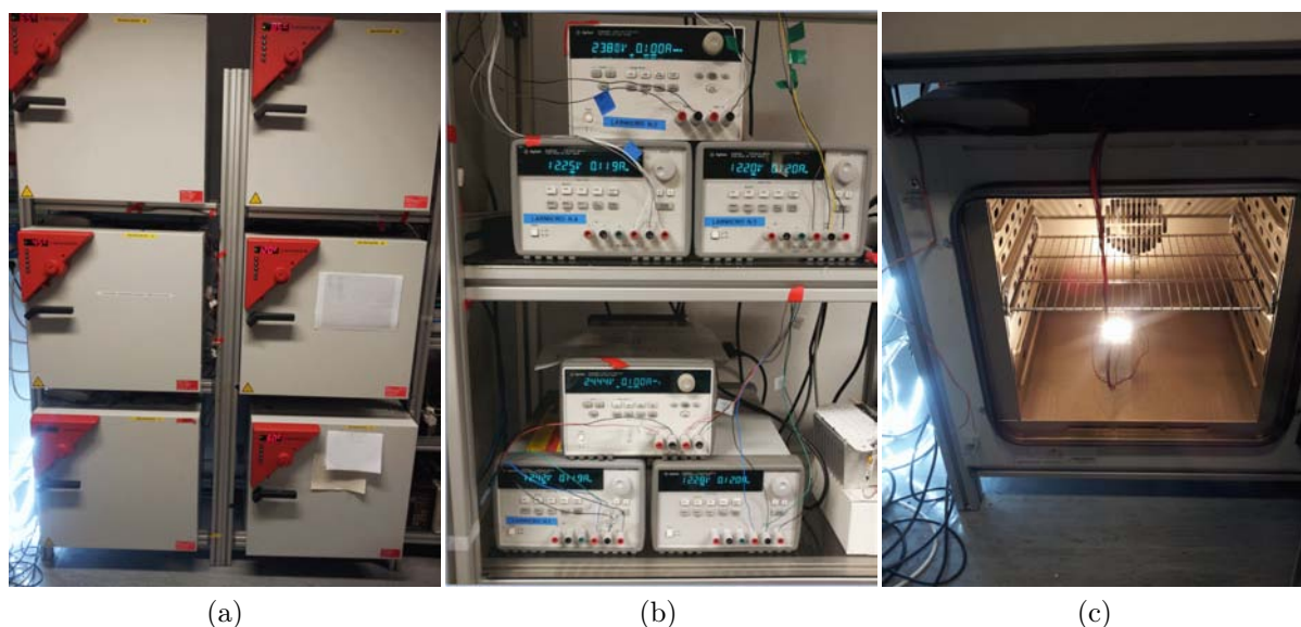
Figura 4.15: Batteria di forni utilizzati per lo stress dei dispositivi (a). Alimentatori adibiti alla polarizzazione dei campioni durante lo stress (b). Posizionamento dei campioni accesi all'interno del forno (c).
