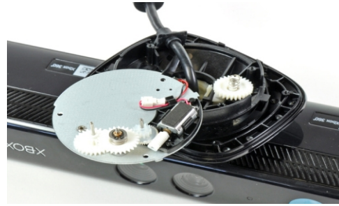
Figura 1.12: particolare del sistema di regolazione dell'inclinazione
