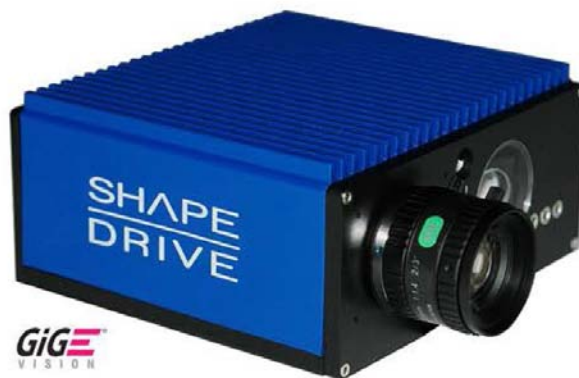
Figura 1.4: Telecamera ShapeDrive serie SD. E' ben visibile il proiettore nella parte destra; la ricezione dell'immagine viene affidata da un'ottica ed un sensore da B/N da 3 Mpixel
