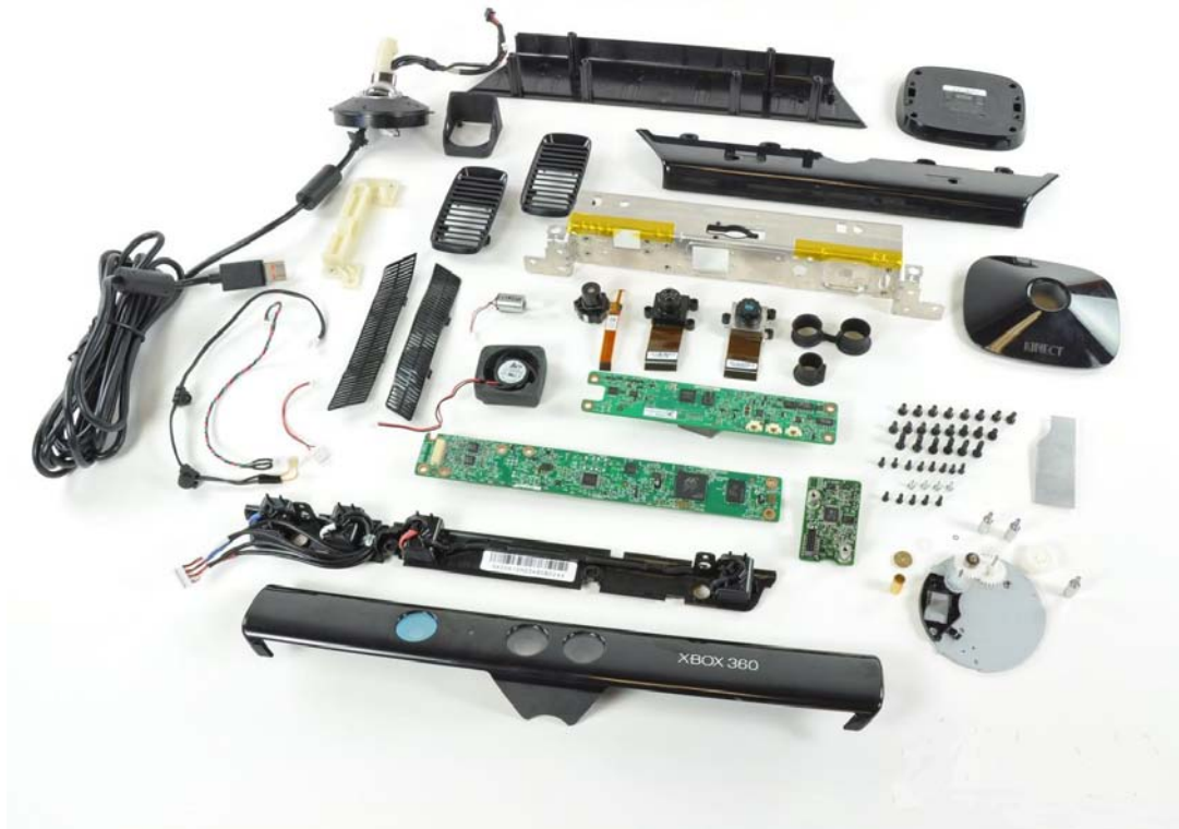
Figura 1.13: disassemblaggio del Microsoft Kinect™
