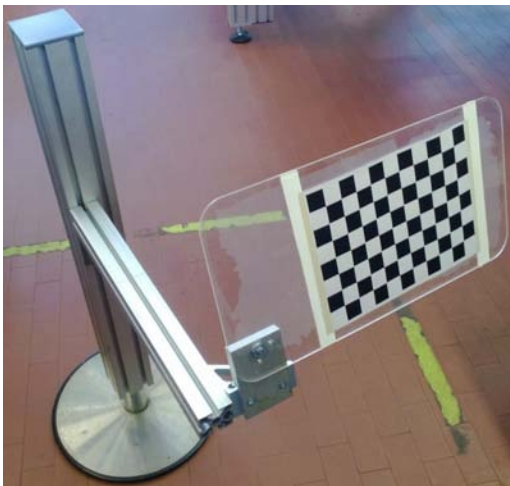
Figura 4.5: sistema di fissaggio della matrice di acquisizione
