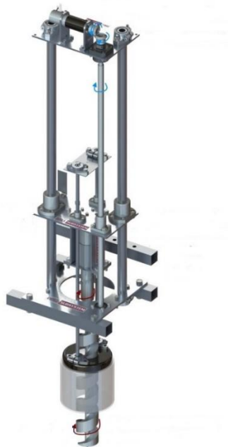
Fig. 1.4 Immagine del trapano che verrà usato per il task di trivellazione. Fonte: Morpheus Team 2015
