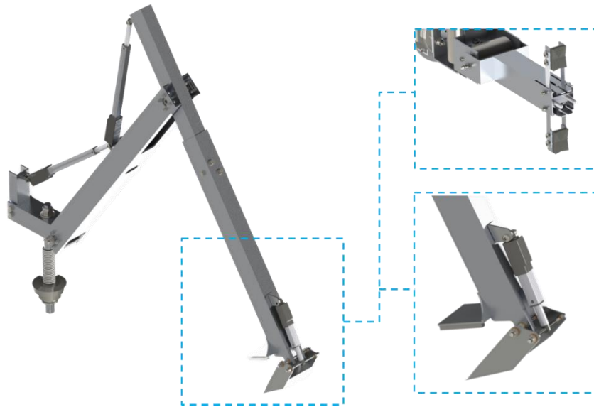
Fig. 1.3 Immagine del braccio e dei due end-effectors che verranno utilizzati. Fonte: Morpheus Team 2015
