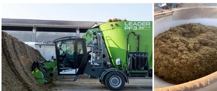
Foto 5 (sinistra): Fase di desilamento per la preparazione del piatto unico, nel fianco del cassone del carro miscelatore è visibile un apparecchio NIR per l'analisi del TMR.
