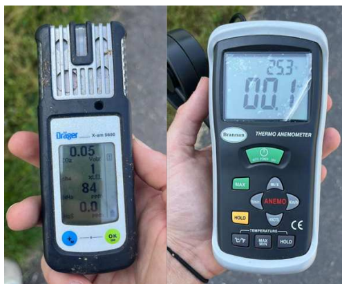
Foto 10 (sinistra): Dräger X-am® 5600 usato per valutare le concentrazioni dei gas presenti in allevamento.
