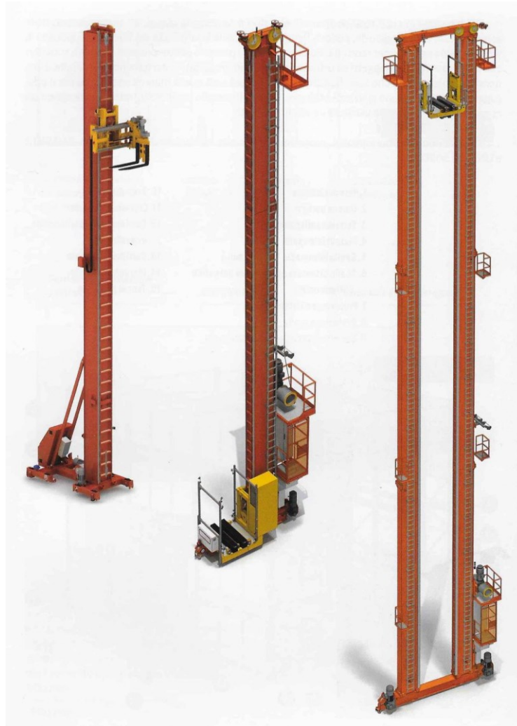
Figura 2.2: Differenti tipologie di trasloelevatori
