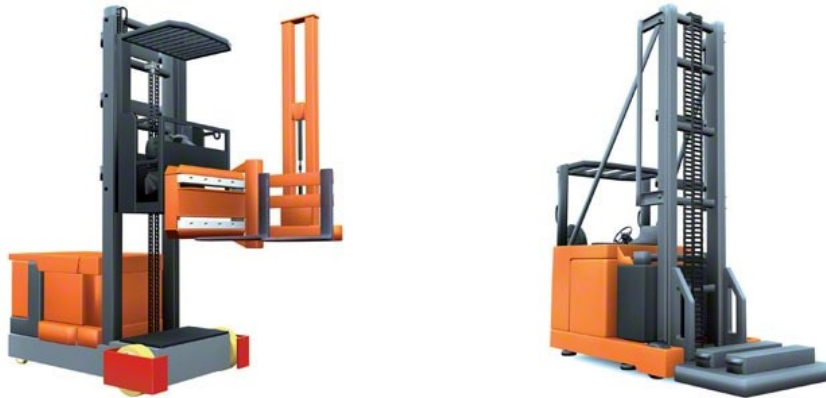
Figura 1.18: Carrello elevatore trilaterale (sinistra) e bilaterale (destra)
