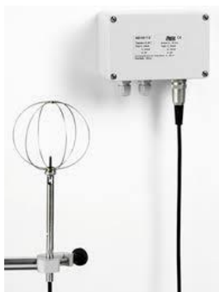
Figura 3.29 Anemometro a filo caldo HD 103T.0. A sinistra l'elemento sensibile, a destra l'acquisitore.
