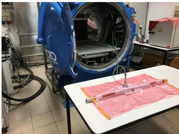
Figura 98 Test del vuoto per il sacco in cui è contenuto il tubo in fibra di vetro e introduzione del tubo nell'autoclave
