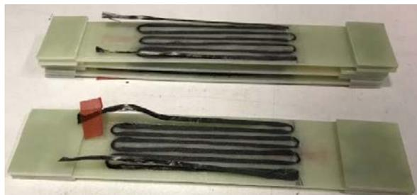
Figura 63 Provini con bundle a griglia estensimetrica con tab alle estremità
