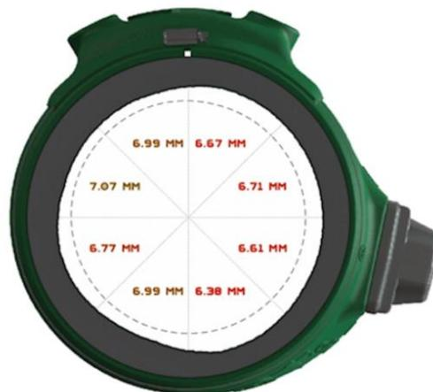
Figura 30 Software che rileva lo spessore del tubo in analisi con le GUW.
