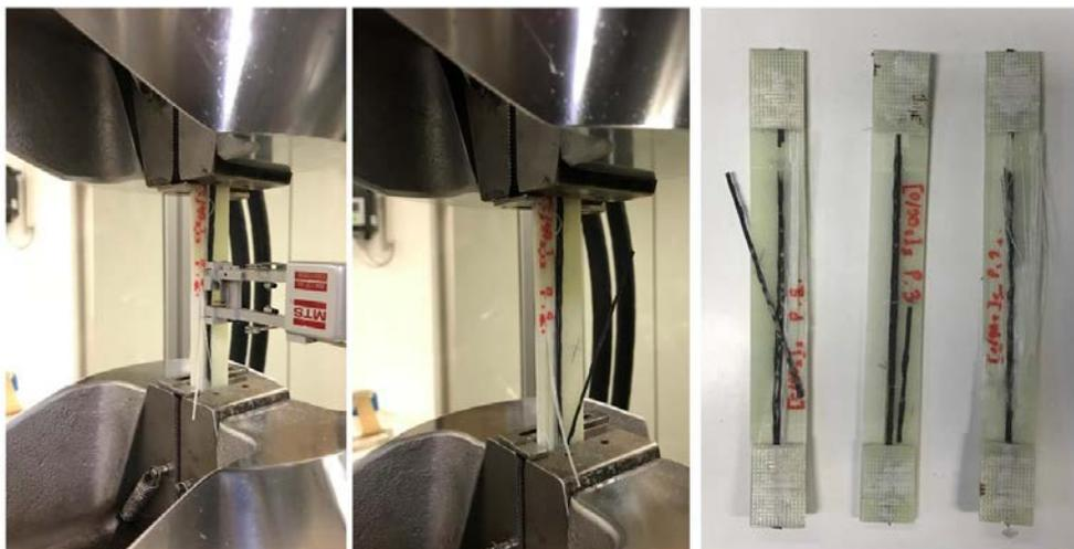
Figura 55 Da sinistra a destra: Set- up della macchina con estensimetro, provino rotto dopo la prova di trazione, provini rotti dopo le prove di trazione.
