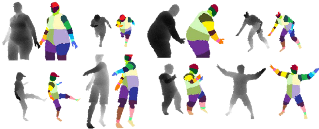
Figura 4.5: Esempi di depth image e corrispondente body part label image del training set dello skeletal tracker.
