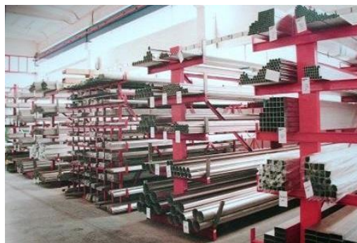
Figura 1.3 - Stoccaggio di materiali speciali su scaffalatura cantilever.
