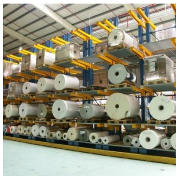
Figura 1.3 - Stoccaggio di materiali speciali su scaffalatura cantilever.
