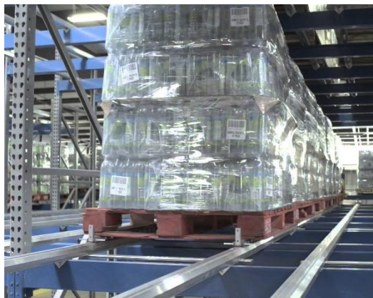
Figura 1.9 - Nella foto si nota come il pallet, posizionato di lato e non di punta, posa unicamente su due profili esterni e non sui tradizionali correnti.
