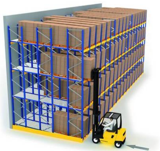
Figura 1.8 - Magazzino a gravità con logica LIFO.
