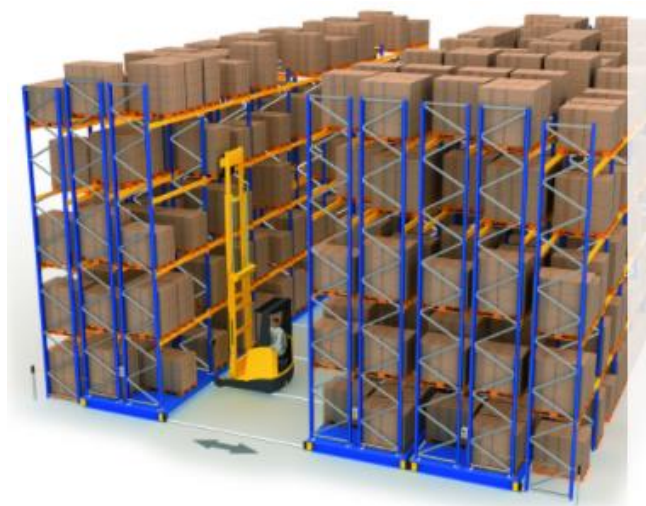
Figura 1.14 - Magazzino compattabile con scaffalature montate su rotaie.
