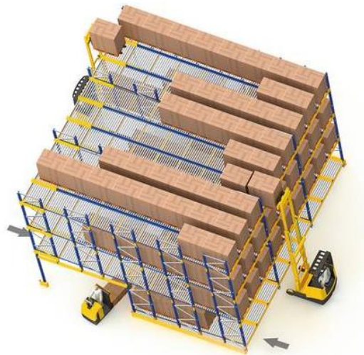
Figura 1.7 - Magazzino a gravità con logica FIFO.
