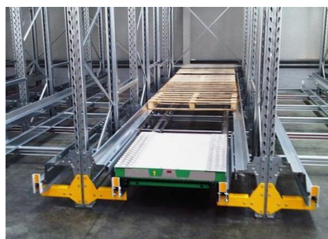
Figura 1.13 - Esempio di navetta/satellite in grado di posizionare il pallet sulla prima postazione libera, senza il supporto dell'operatore.
