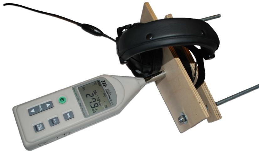
**Figura 3.6:** Setup per la calibrazione delle cuffie: Cuffia, sostegno e fonometro.
