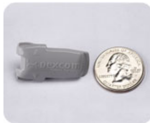
Figura 1.6: Dexcom Seven Plus TM : sensore incorporato al trasmettitore [8].
