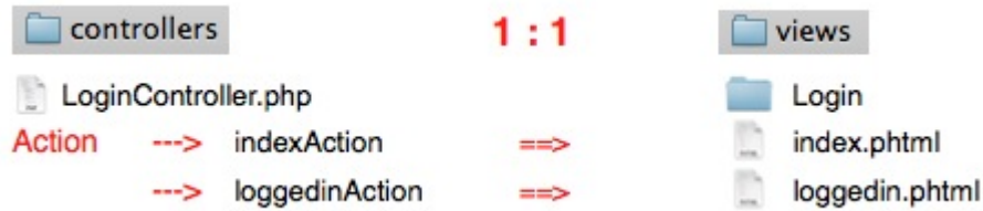
Figure 29: Rapporto tra controller e view
