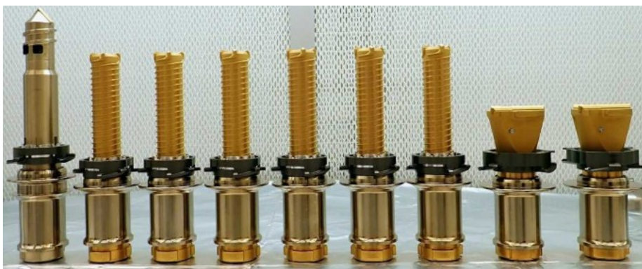
Figura 6: Set delle punte a disposizione del trapano: una da regolite, 6 da carotaggio e 2 abrasive.
