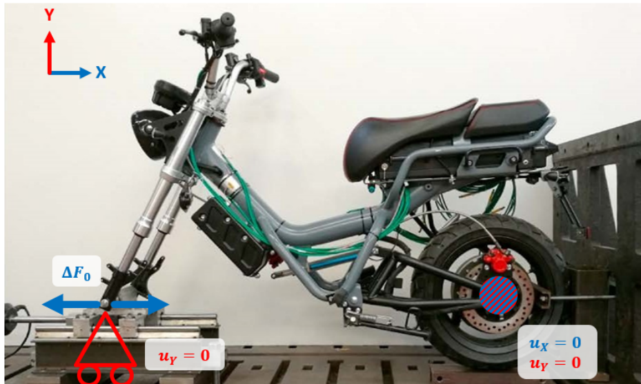
Figura 6.4: Schema di vincolo e carico semplificato del telaio per la condizione di carico orizzontale.
