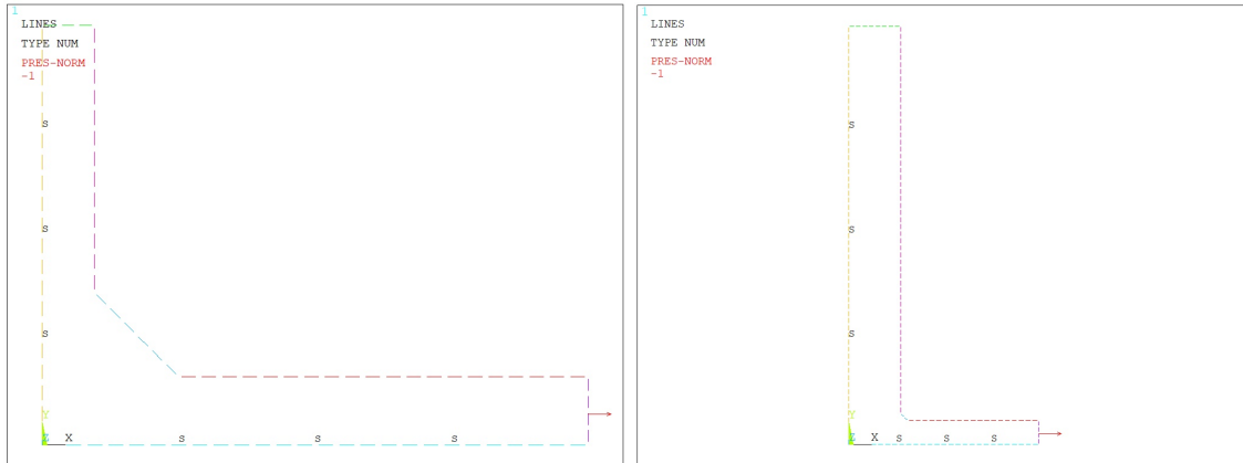
Figura 2.12: Sistema di vincoli e carichi applicato alle geometrie 1 e 12-Cruciform, con riferimento ai modelli per le analisi con il PSM (visualizzazione delle sole linee).
