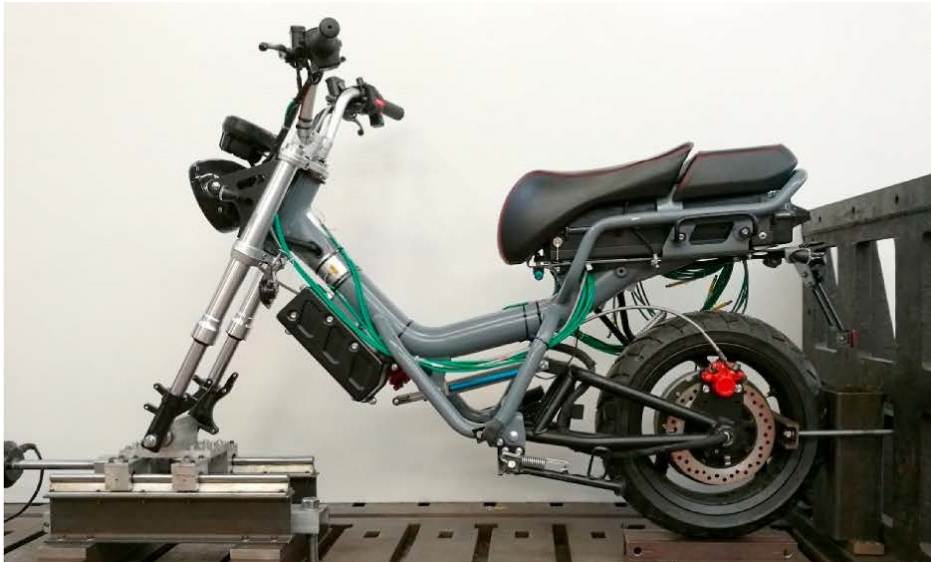
Figura 6.3: Setup del banco prova utilizzato per le prove a fatica per la condizione di carico orizzontale con montato un telaio [37].
