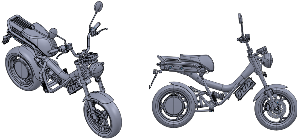
Figura 7.2: Modello SolidWorks® dello scooter Ciclone completo.
