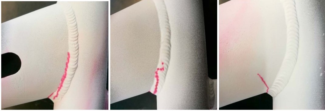
Figura 6.5: Rotture sperimentali nella parte anteriore del telaio dovute alle prove per la condizione di carico orizzontale [37].
