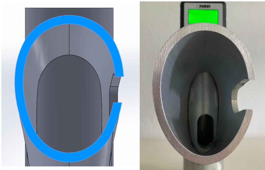
Figura 7.8: Confronto visivo tra la sezione del tubolare principale del modello CAD e la geometria reale.
