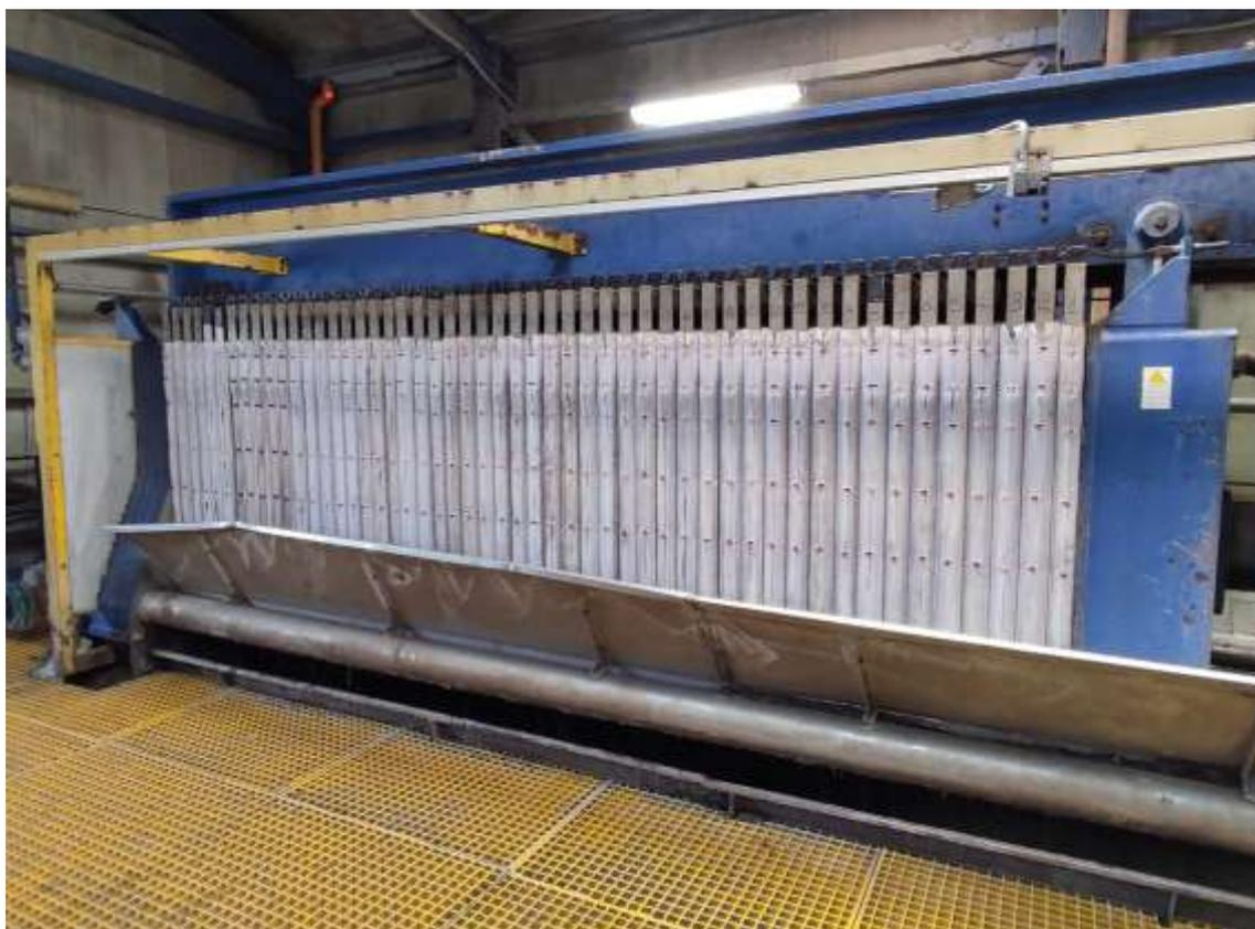
**Figura 2.3:** Filtro A, in cui avviene la separazione tra il tartrato umido e l'acqua usata per il lavaggio
