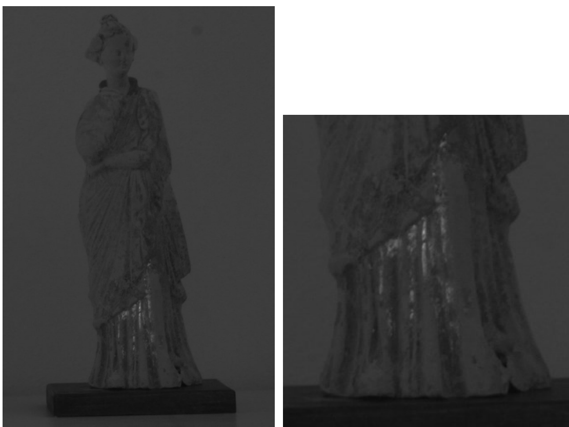
Fig. 38: Immagine VIL dell'intera statuetta e particolare della zona di fluorescenza del blu egizio in corrispondenza del panneggio della veste.
