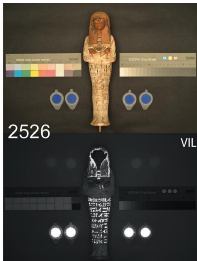
Fig. 4: Esempio di imaging VIL. Sopra: immagine in luce visibile riflessa del campione n° 2526. Sotto: immagine VIL corrispondente, che mostra la presenza di blu egiziano nel copricapo e nei geroglifici. Lo standard blu egiziano è mostrato nella parte inferiore delle immagini (manufatti egiziani presso il Museo Egizio di Torino)
