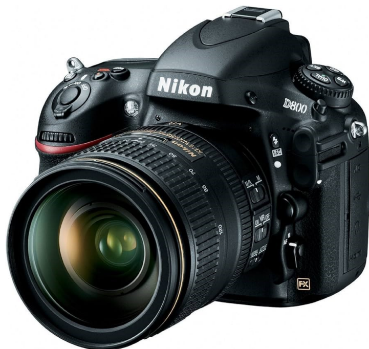
Fig. 2: Esempio di fotocamera Full Range utilizzabile per le acquisizioni: Nikon D800 FR. Fotocamera reflex digitale a obiettivo singolo (DSLR) con attacco F per obiettivo intercambiabile; Dimensione del sensore Full Frame 35,9 × 23,9 mm; 46 megapixel (8256 × 5504 pixels); Full Range modificato: sensibilità tra 340 to 1100 nanometri ( www.profilocolore.com )
