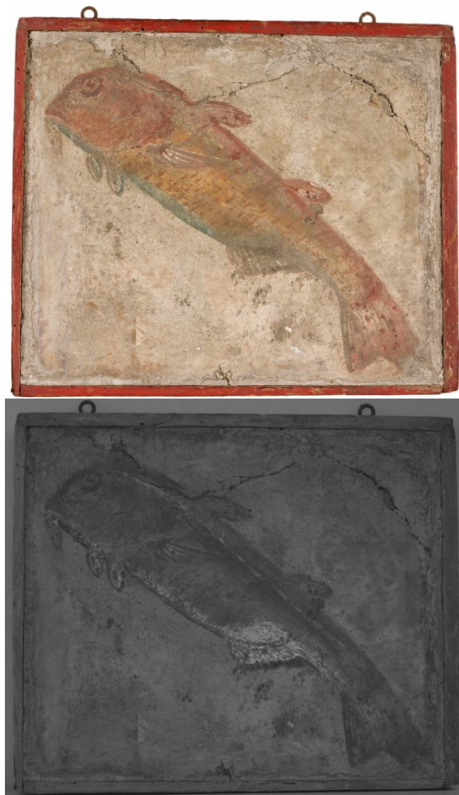
Fig. 30: Immagine VIS (sopra) e VIL (sotto) a confronto. Evidente la fluorescenza del pigmento di blu egizio in corrispondenza della pinna anale
