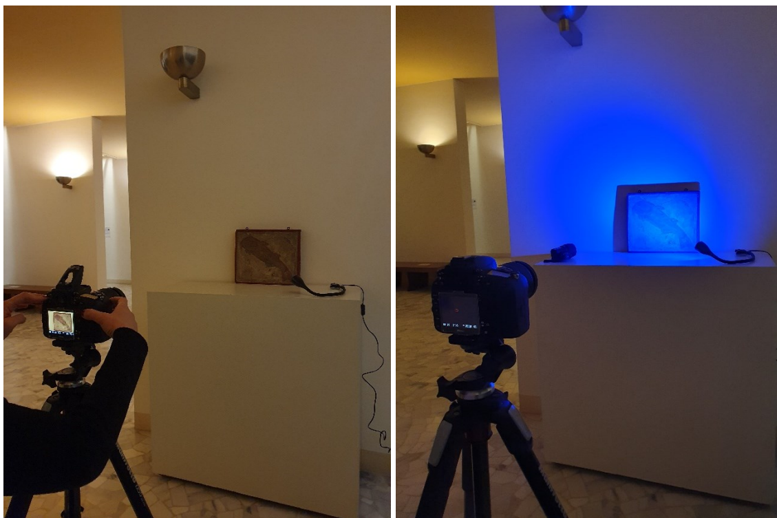
Fig. 22: Esempio di ripresa. A sinistra si può osservare la preparazione della macchina fotografica per scattare la fotografia VIL (in particolare la messa a fuoco nel visibile). A destra si osserva lo scatto della fotografia VIL, con l'ausilio del faretto LED blu.
