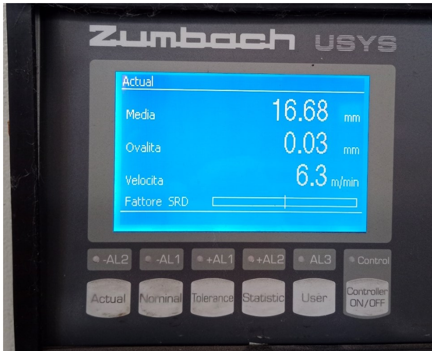
Figura 21: Sistema di controllo del diametro esterno, eccentricità e velocità della linea
