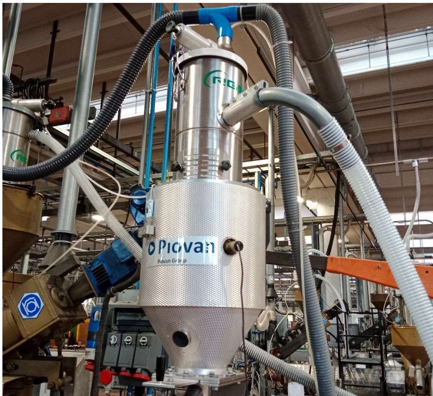
Figura 22: Sistema di alimentazione dell'estrusore
