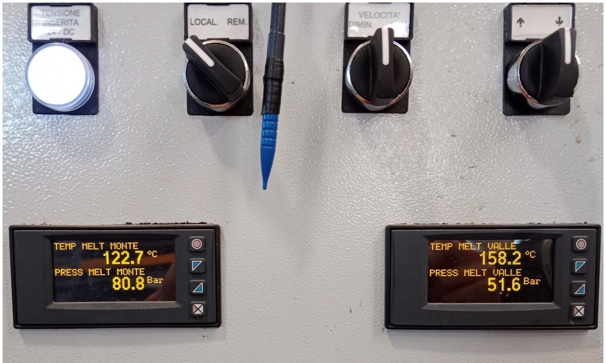
Figura 19: Schermata per la lettura in tempo reale della pressione e temperatura prima e dopo la breaker plate
