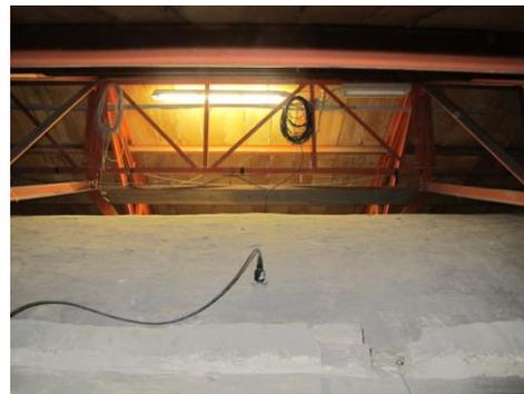
Fig. 6.9. Applicazione dei sensori di accelerazione sull'estradosso della volta a botte, A7 e A8.
