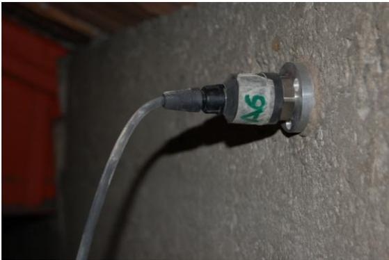
Fig. 6.8. Applicazione del trasduttori di accelerazione A6.
