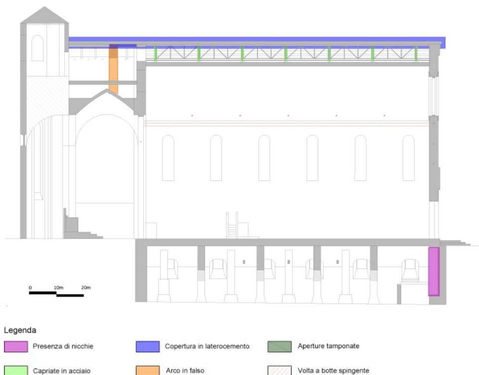
Fig. 2.90. Vulnerabilità, sezione BB.
