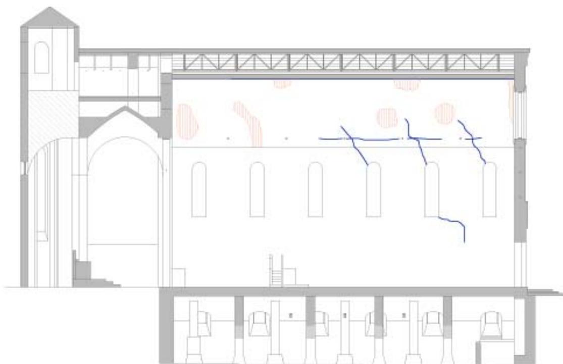
Fig. 2.76. Quadro fessurativo e degrado, sezione BB, si veda la tav. 6.08 presente nel book di tavole allegato.
