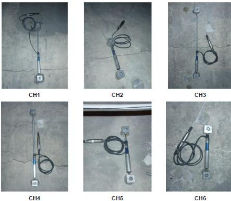
Fig. 5.17. Immagine di riferimento di ogni sensore installato.
