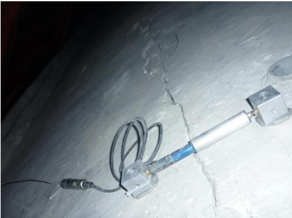
Fig. 5.19. Disposizione dei potenziometri sulle lesioni longitudinali site all'estradosso della volta.
