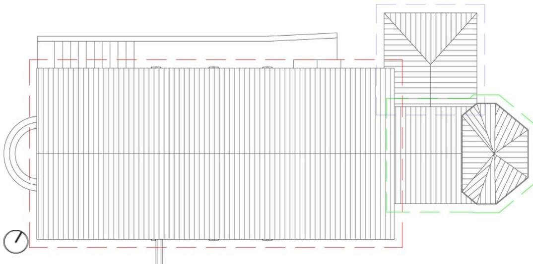
Fig. 2.60. Pianta delle coperture che illustra la composizione delle Unità Strutturali.
