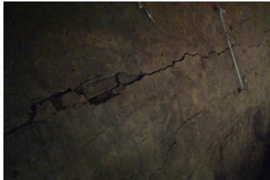
**Fig. 6.3.** Applicazione dei trasduttori di spostamento alle lesioni che interessano longitudinalmente l'estradosso della volta dipinta.
