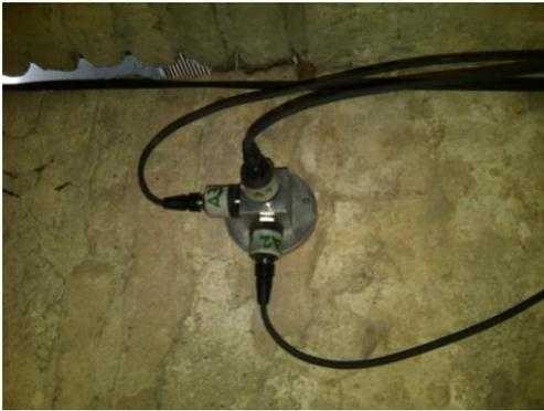
Fig. 6.6. Applicazione dei trasduttori di accelerazione A1, A2 e A3 nella cripta.
