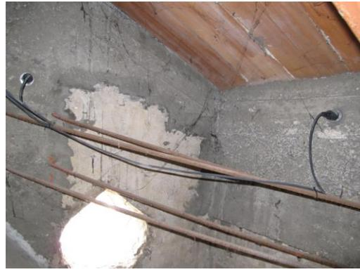
Fig. 6.7. Applicazione dei trasduttori di accelerazione A4 e A5.
