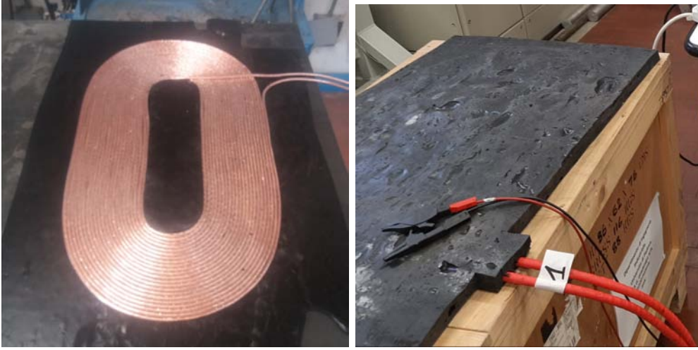
Figura 4.2: Fotografie del prototipo prima e dopo la fusione degli strati elastomerici.
