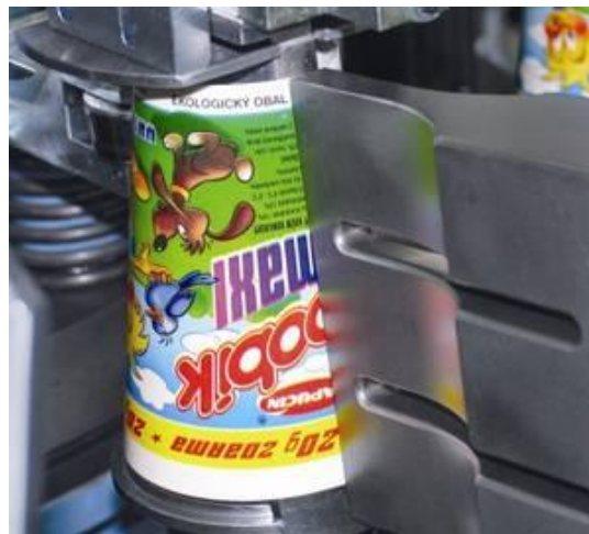
Figura 1.2: Esempio di utilizzo degli ultrasuoni per saldatura di carta o simili.
