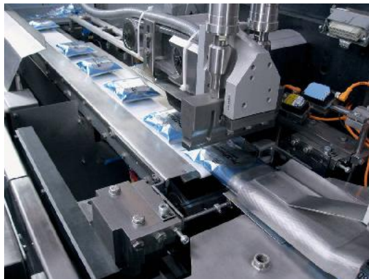
Figura 1.4: Esempio di utilizzo degli ultrasuoni per il packaging alimentare nelle catene automatizzate.
