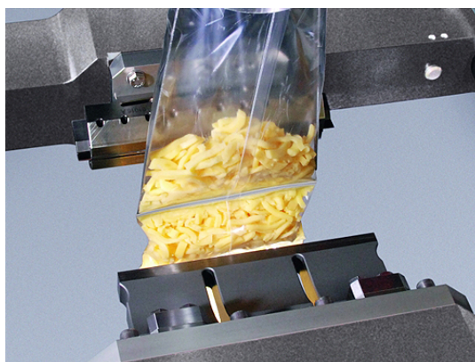
Figura 1.5: Esempio di utilizzo degli ultrasuoni per il packaging alimentare: il surriscaldamento è molto localizzato e non si ha danneggiamento dei cibi.
