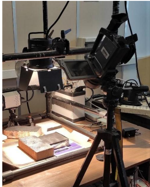
Figura 3.1: Setup sperimentale. Come si nota, la distanza tra termocamera e campione è ridotta e l'asse di vista è inclinato rispetto alla superficie del campione per evitare riflessioni dirette della fonte luminosa.
