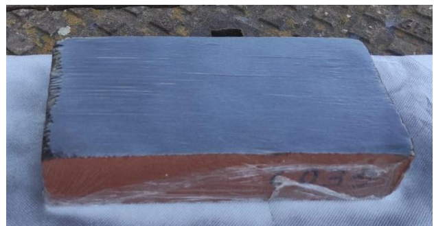
Figura 3.3: Si mostra il campione S2 dopo essere stato avvolto nella pellicola, successivamente dipinta.
