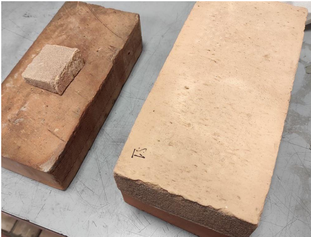
Figura 2.1: A destra è visibile il mattone dell'Arsenale di Venezia S1 utilizzato per le misurazioni, a sinistra una sezione di un mattone della stessa tipologia utilizzata per la misura di porosità.
