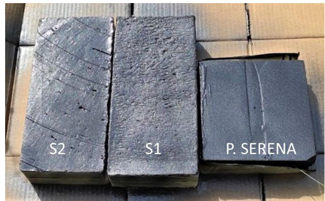
Figura 3.2: Immagine dei due mattoni oggetto di analisi ( S1 e S2 ) e della pietra Serena, subito dopo essere stati dipinti.
