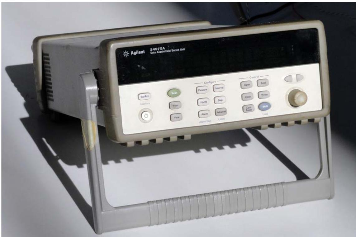
Figura 3.7: Unità Agilent 34970A per l'acquisizione di segnali di varia natura. In questa sede è utilizzata per il monitoraggio del segnale di temperatura.
