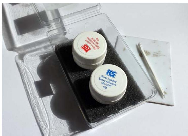
Figura 4.4: Colla bicomponente caricata argento.
