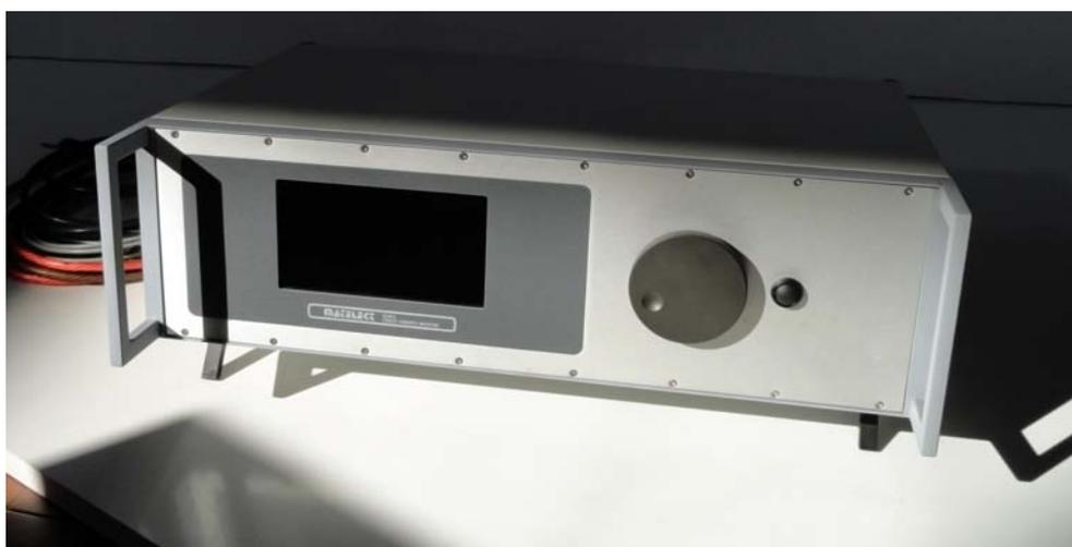
Figura 3.12: Unità Matelect DCM-2 per il rilievo del danneggiamento durante un test a fatica.
