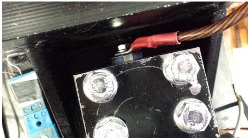
Figura 4.12: Dettaglio dell'afferraggio in macchina lato colonna. Si può vedere la distanza di 5 mm tra estremità del provino e morsa, nonché il collegamento al cavo di ponte (rosso) della Matelect.
