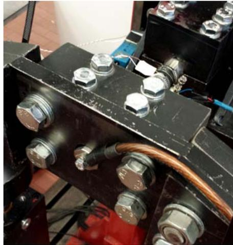
Figura 4.13: Dettaglio - per la configurazione macchina A - del posizionamento del provino nell'afferraggio lato martinetti.
