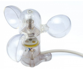
Figura 3.11: Anemometro a coppe.
