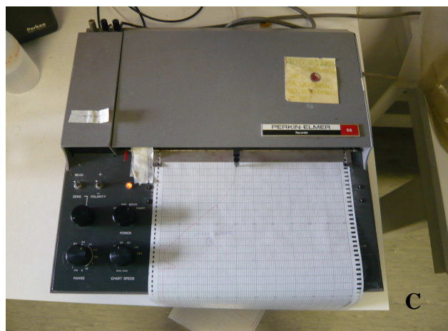
Figura 3C: registratore collegato all'ossigrafo per la misurazione delle variazioni di concentrazione di ossigeno nel mezzo di analisi
