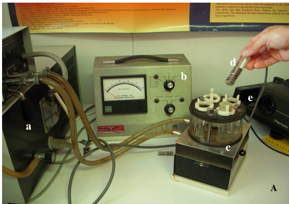
Figura 3A: ossigrafo utilizzato per l'analisi dell'emissione fotosintetica e del consumo respiratorio di ossigeno da tessuti fogliari in vivo (YSI-5331, Spring Instruments). (a) bagno termostatico per il mantenimento della temperatura di analisi a 20°C; (b) ossigrafo; (c) provette di analisi; (d) elettrodo di Clark; (e) proiettore per il rifornimento di luce per la fotosintesi
