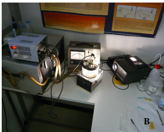
Figura 3B: analisi in atto di emissione di O 2 alla luce da pezzetti di tessuto fogliare
