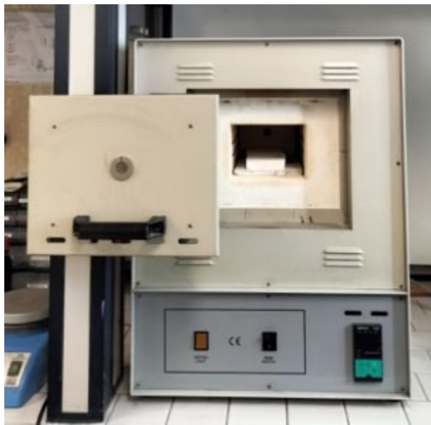
Figura 5.5: forno a muffola utilizzato per le prove di riscaldamento in aria.
