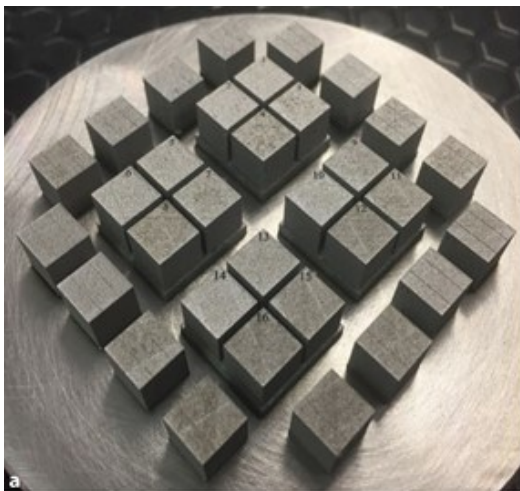
Figura 2.30: immagine dei cubetti in Tungsteno prodotti a sinistra; grafico dell'ottimizzazione di scan speed e hatch distance a destra [27].
