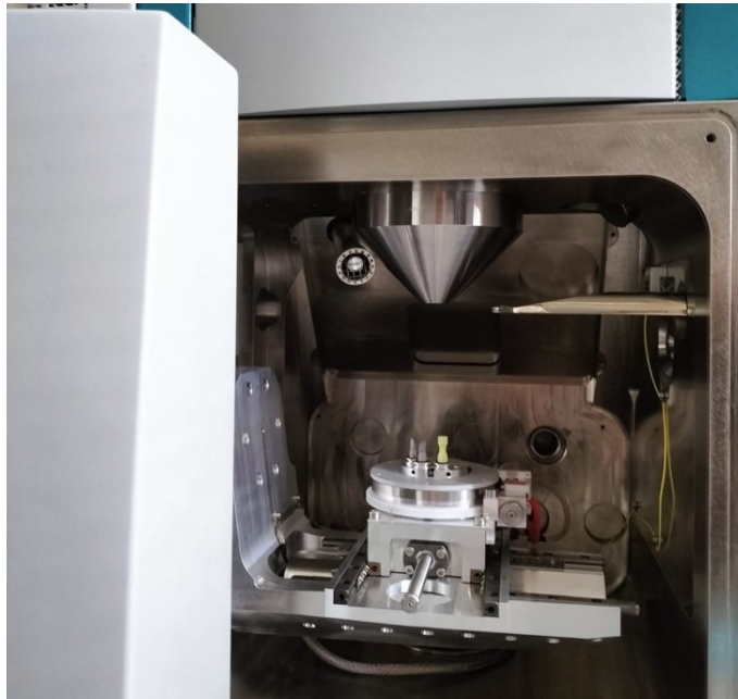
Figura 4.8: vista dell'interno della camera interna del microscopio elettronico a scansione (SEM) ai LNL.
