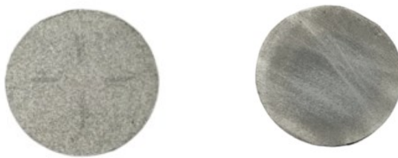
Figura 3.30: campione 2 AM prodotto in Belgio pre e post riscaldamento.
