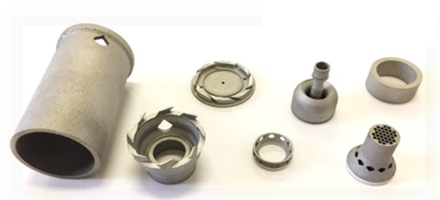
Figura 2.34: componenti della sorgente di ionizzazione al plasma in lega AlSi10Mg realizzati tramite SLM.
