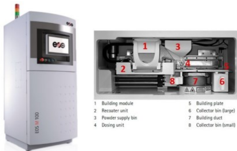
Figura 2.28: macchina di stampa EOS M100 a sinistra e immagine dell'interno a destra.
