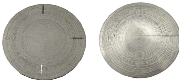
Figura 3.19: immagini del campione 1_STD. A sinistra prima del riscaldamento; a destra dopo il riscaldamento.
