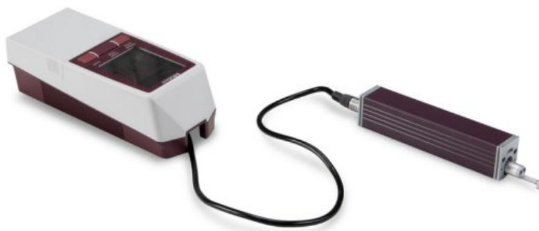
Figura 3.9: immagine del rugosimetro Mitutoyo® usato ai LNL.
