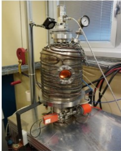
Figura 3.6: camera da vuoto vista dall'esterno.
