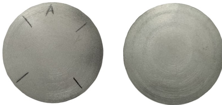
Figura 3.23: a sinistra, provino 5_STD pre riscaldamento; a destra, provino 5_STD post riscaldamento.
