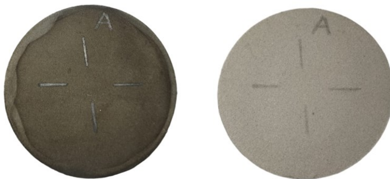
Figura 3.24: a sinistra, provino 1_AM pre riscaldamento; a destra, provino 1_AM post riscaldamento.
