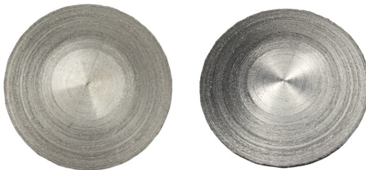
Figura 3.22: a sinistra, provino 4_STD pre riscaldamento; a destra, provino 4_STD post riscaldamento.
