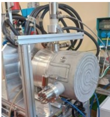
Figura 4.5: immagine della camera da vuoto chiusa, vista dall'esterno.
