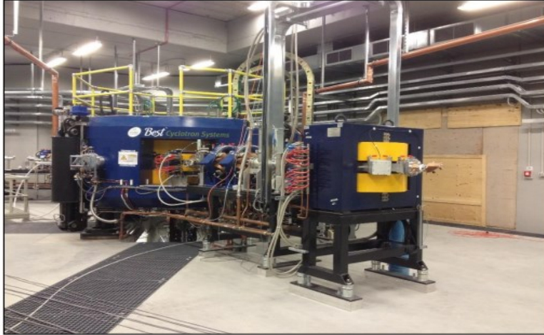
Figura 1.11: fotografia del ciclotrone BEST 70p sviluppato dalla Best Cyclotron Systems, In. presente all'interno della facility SPES ai Laboratori Nazionali di Legnaro.
