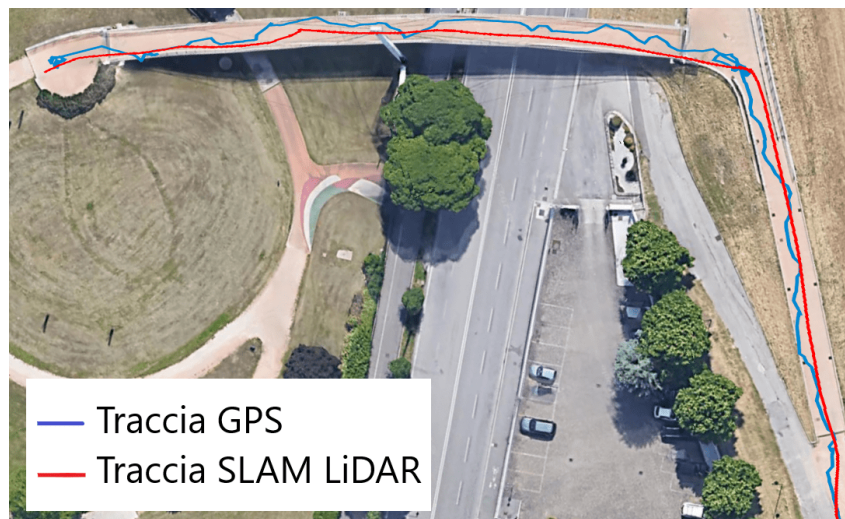
Figura 6.4: Confronto della ricostruzione del percorso tramite la SLAM con le immagini satellitari e il GPS.
