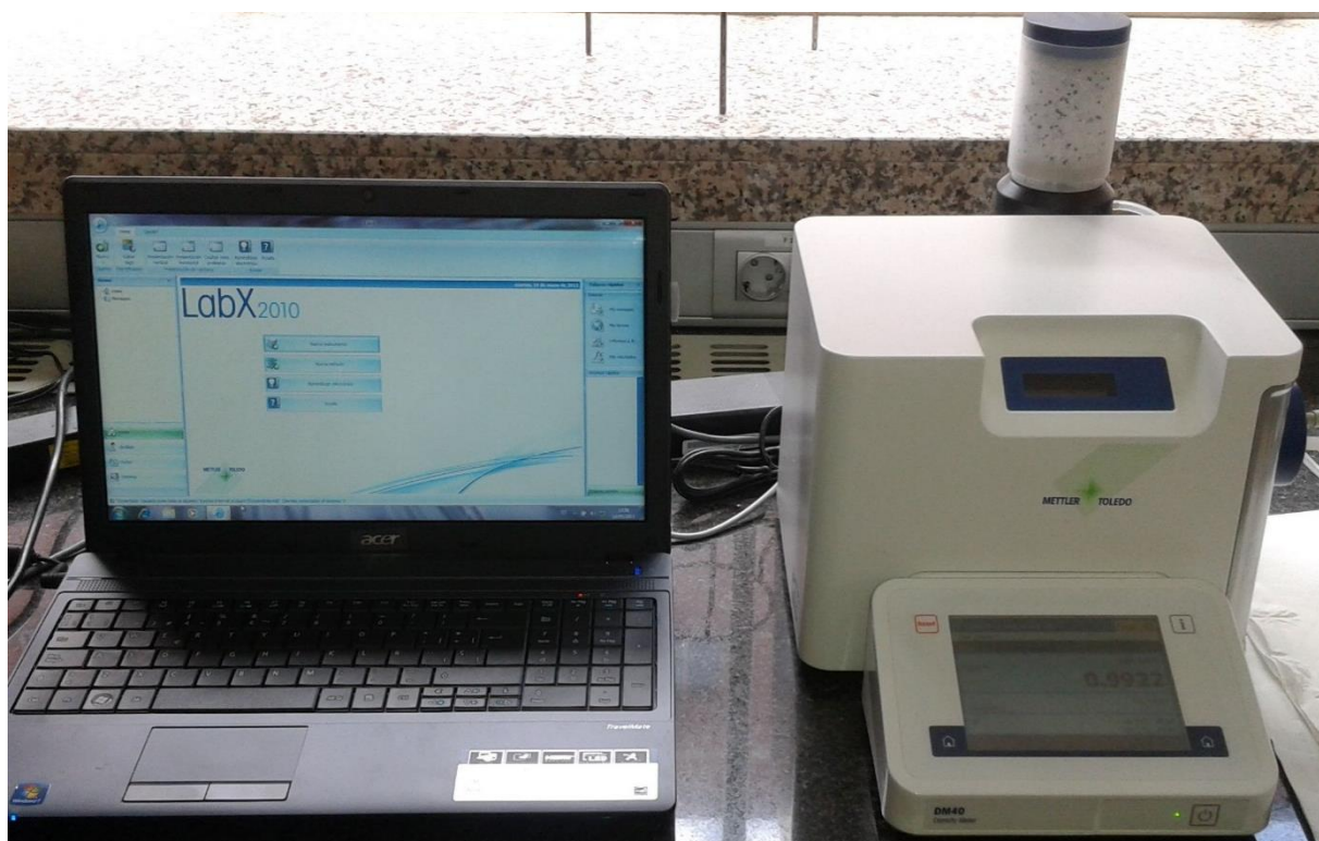
Figura 3.1 Picnometro automatico per la misura della densità di liquidi a diverse temperature.
