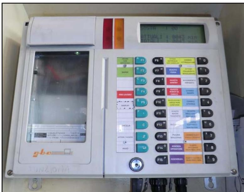
Figura 3.2.1.1 Dispositivo Kienzle installato presso l'isola di lavorazione Mazak 630\_2
