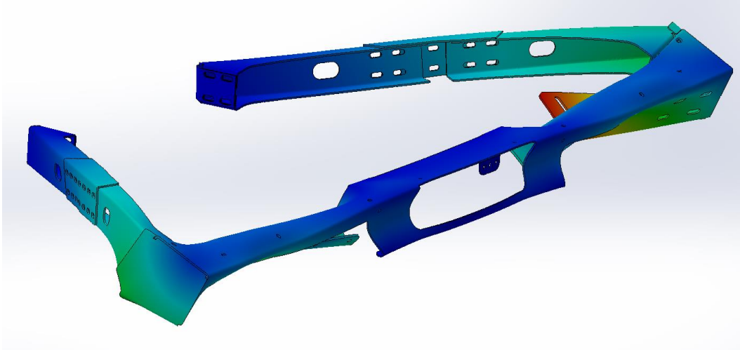
Figura 4.3.2.2.b Deformazione della testata posteriore del controlaio innovativo e modulare, sottoposta al carico
