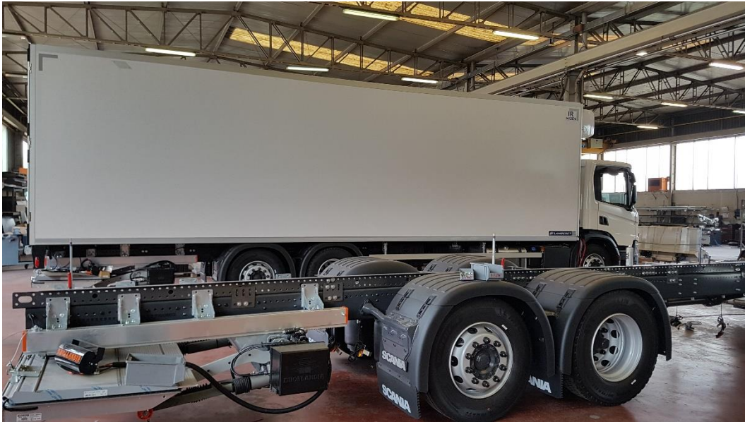
Figura 5.6.b Assemblaggio di un controtelaio innovativo e modulare, direttamente nel reparto di finitura. In secondo piano, un allestimento con controtelaio innovativo e modulare completato.
