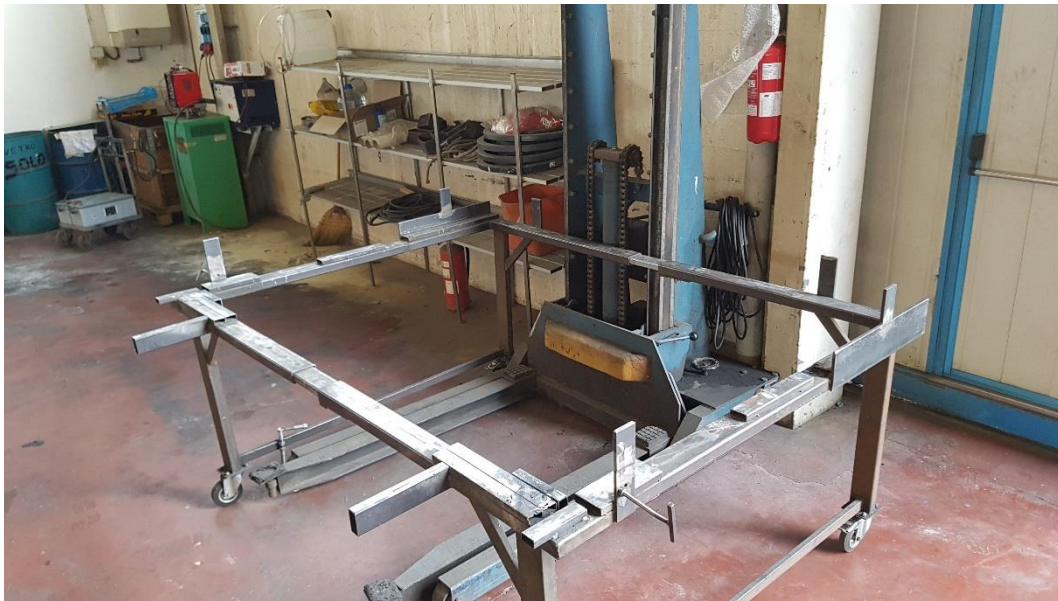
Figura 3.1.3. Dima per l'assemblaggio del troncone posteriore
