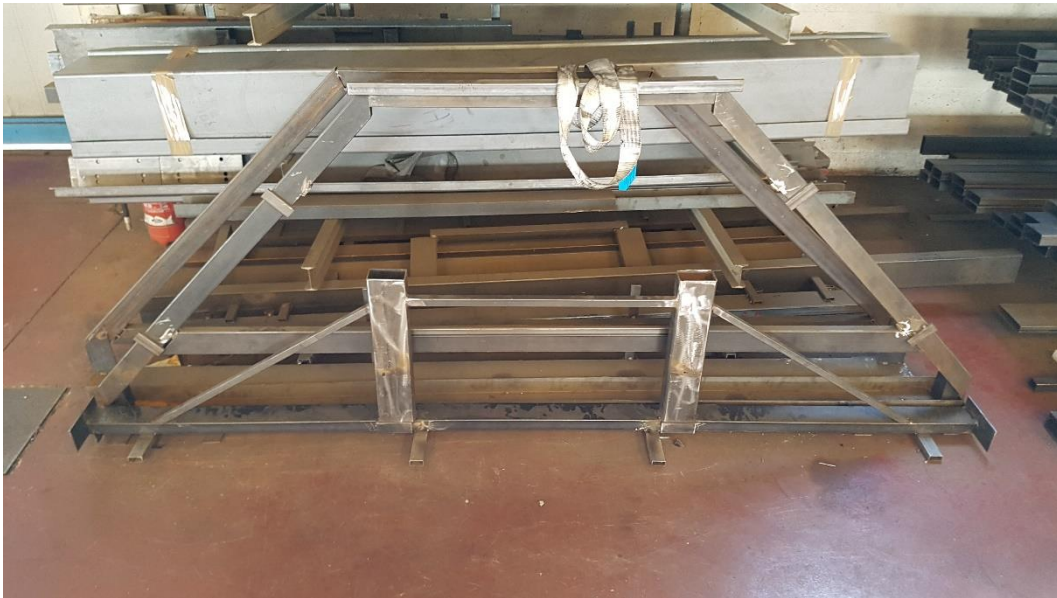
Figura 3.1.4. Dima per la produzione del semiassemblato Testata posteriore
