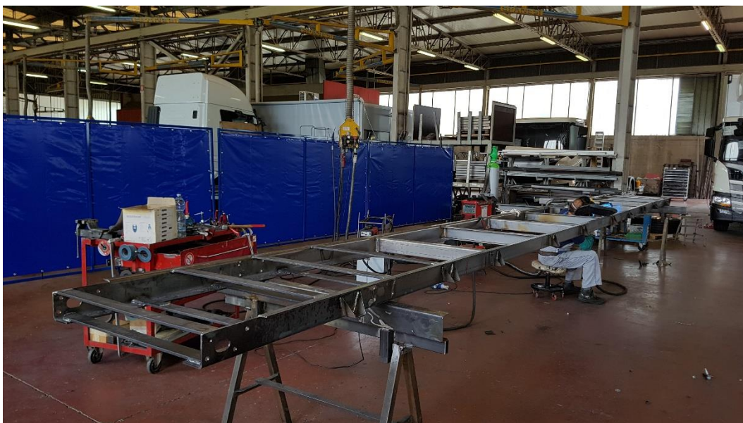
Figura 1.3.3. Produzione tradizionale di un controtelaio per un allestimento frigorifero pesante su Mercedes Actros. La struttura, separata dal veicolo con il carro ponte, viene appoggiata su cavalletti per permettere all'operatore di completarne le saldature.
