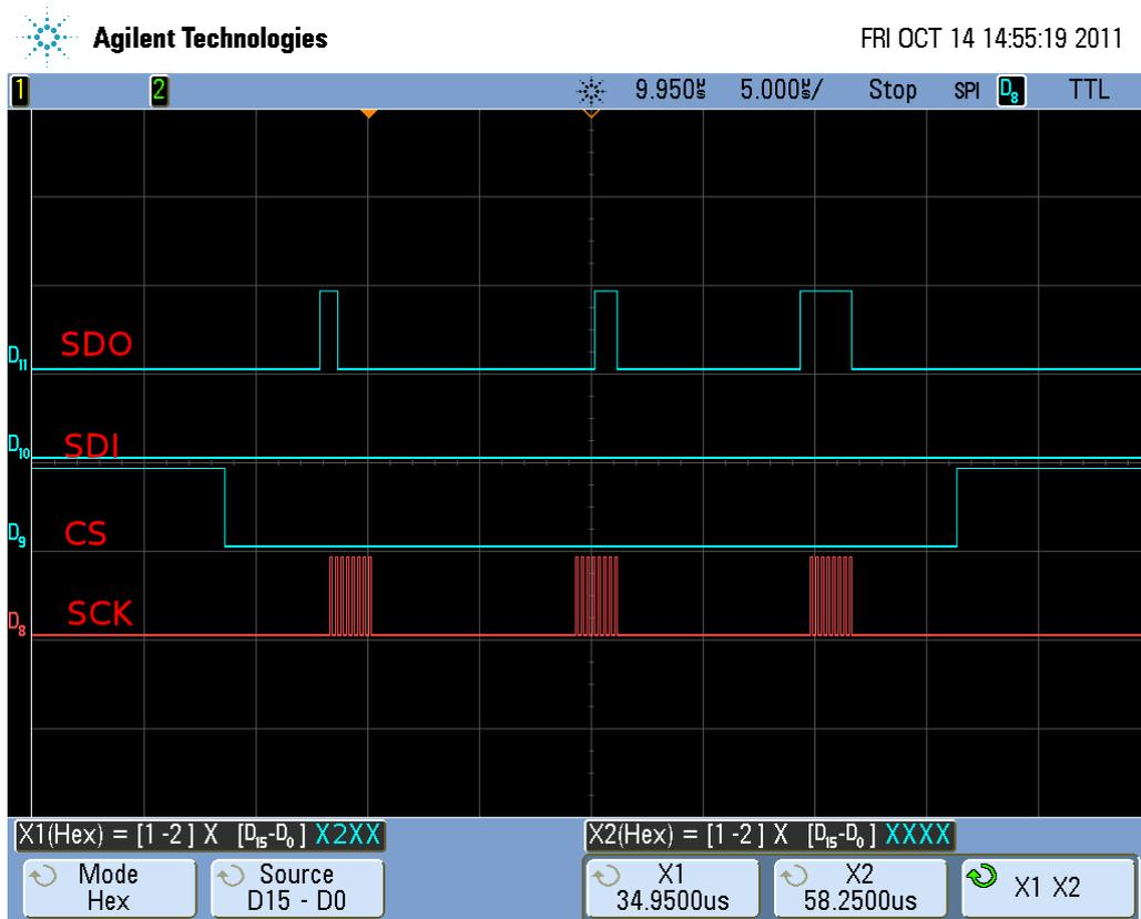
Figura 7.5: Scrittura di un registro long via SPI
