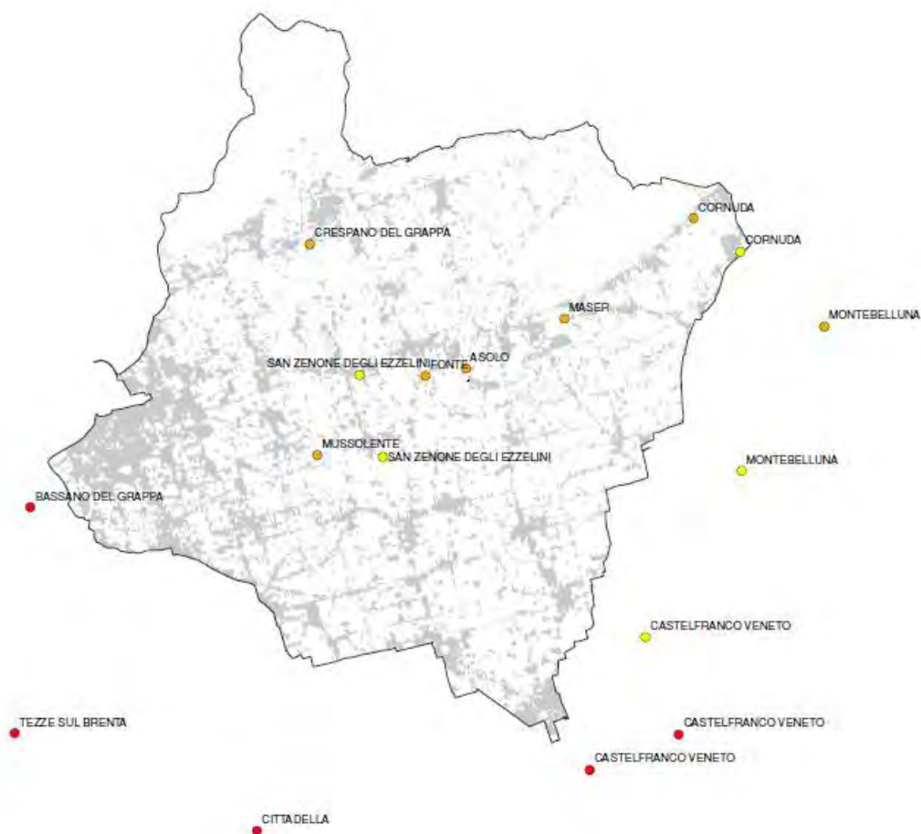
Figura 2.6: impianti di trattamento delle acque reflue; essi sono classificati come prima categoria se per più di 13000 abitanti equivalenti (rosse), seconda categoria per quelle che servono da 1000 a 12999 abitanti (arancioni) e terza categoria per quelle sotto ai 1000 abitanti (gialle). Le aree urbane sono le zone ombreggiate.
