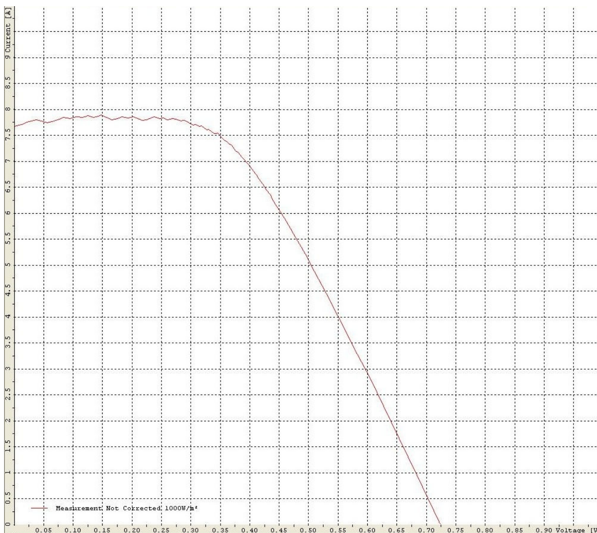
Figura 4.34 – Caratteristica I-V della cella contattata tramite ribbon
