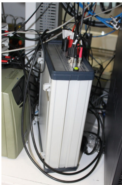
Figura 3.12 – Carico elettronico utilizzato in uno dei simulatori solari in dotazione a Applied Materials
