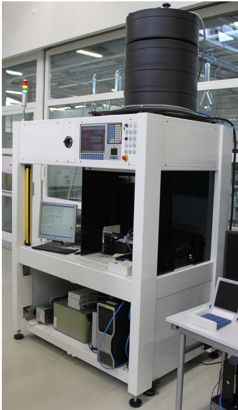
Figura 3.14 – Simulatore solare Berger integrato in un modulo per Softline di Applied Materials
