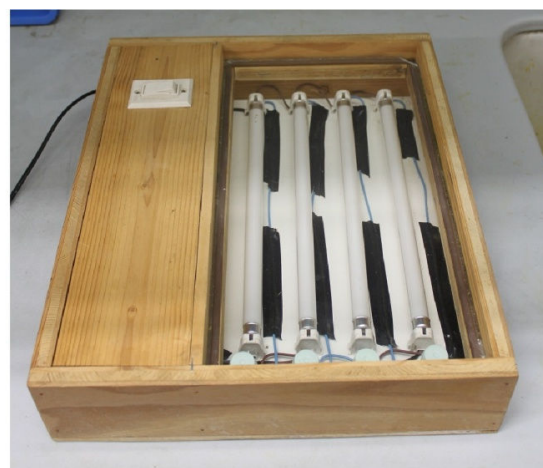
Figura 4.25-a – Distaccante di foto pellicola,percloruro ferrico e vaschette; 4.25-b - bromografo
