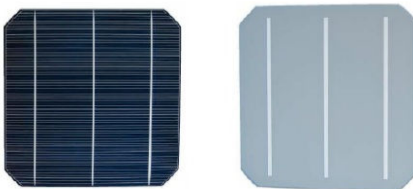
Figura 3.5 – Metallizzazioni di front (sinistra) e back (destra) di una comune cella fotovoltaica (H-pattern)
