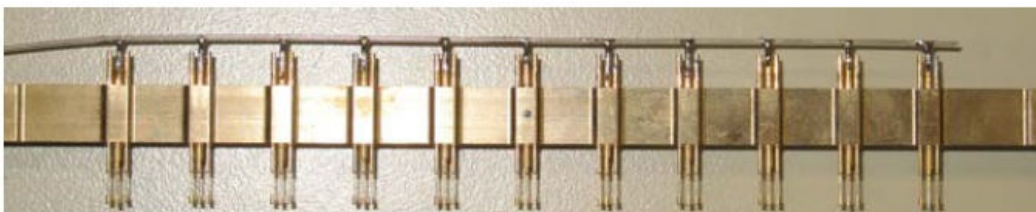
Figura 3.17 – Barra di contatti utilizzata per il tracciamento della curva I-V
