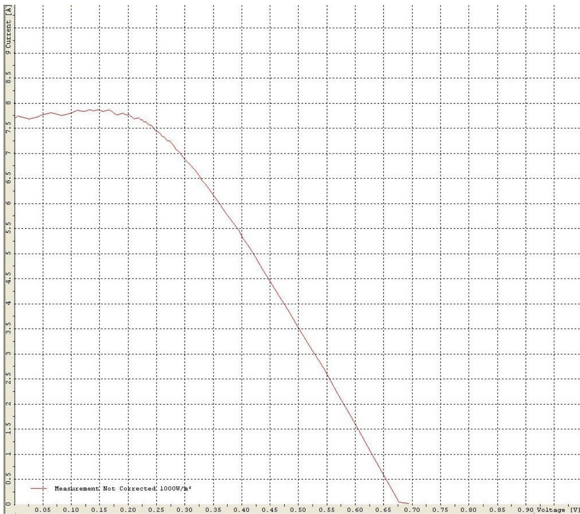
Figura 4.30 – caratteristica corrente tensione del circuito con i resistori in serie ai diodi
