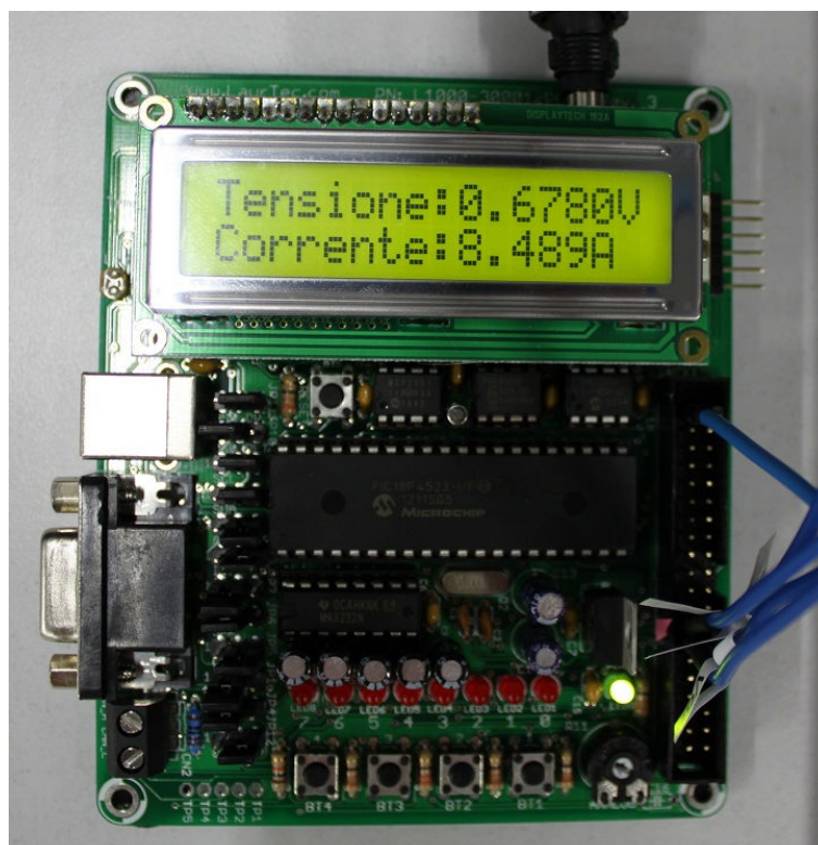
Figura 5.11 – Indicazione dei valori di V_{oc} e I_{sc}
