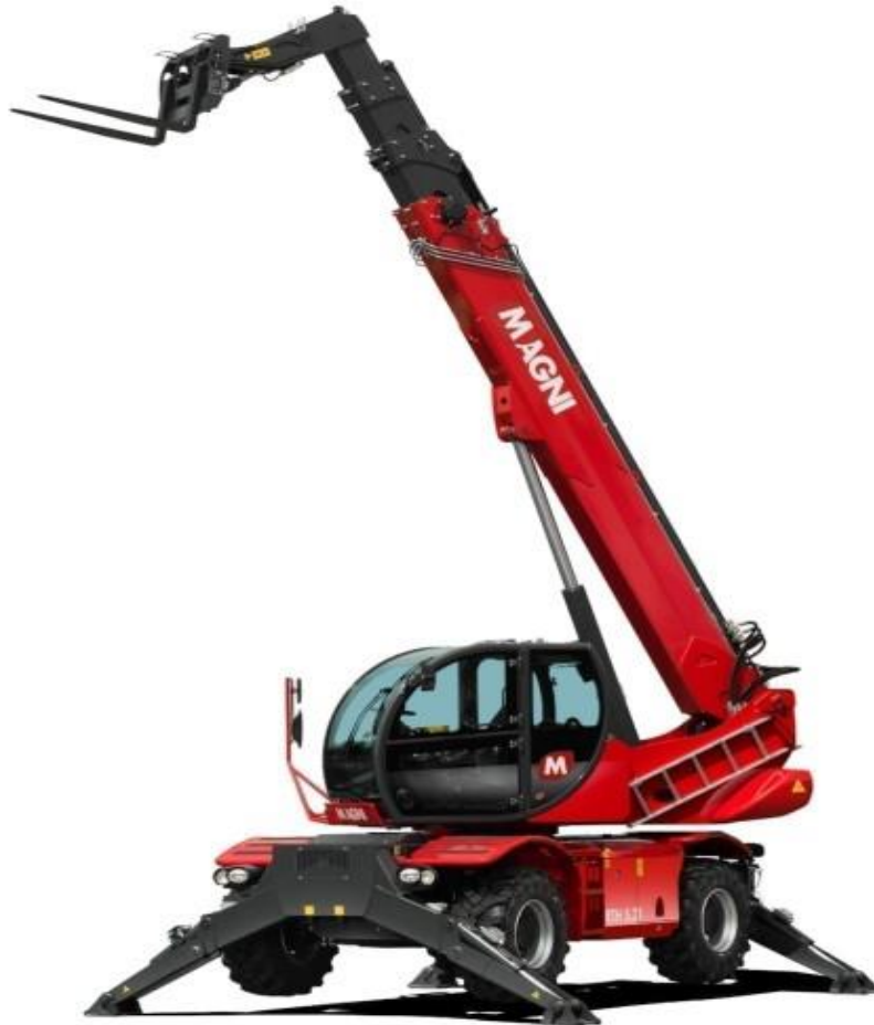
Fig. 14b- Carrello semovente a braccio telescopico rotante
