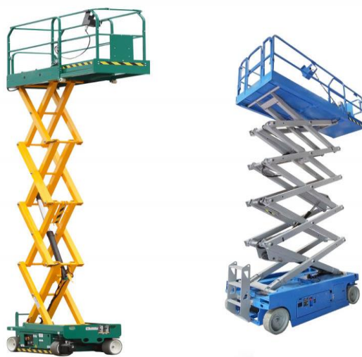
Fig.15- Ponti mobili sviluppabili su carro a sviluppo verticale azionati a mano
