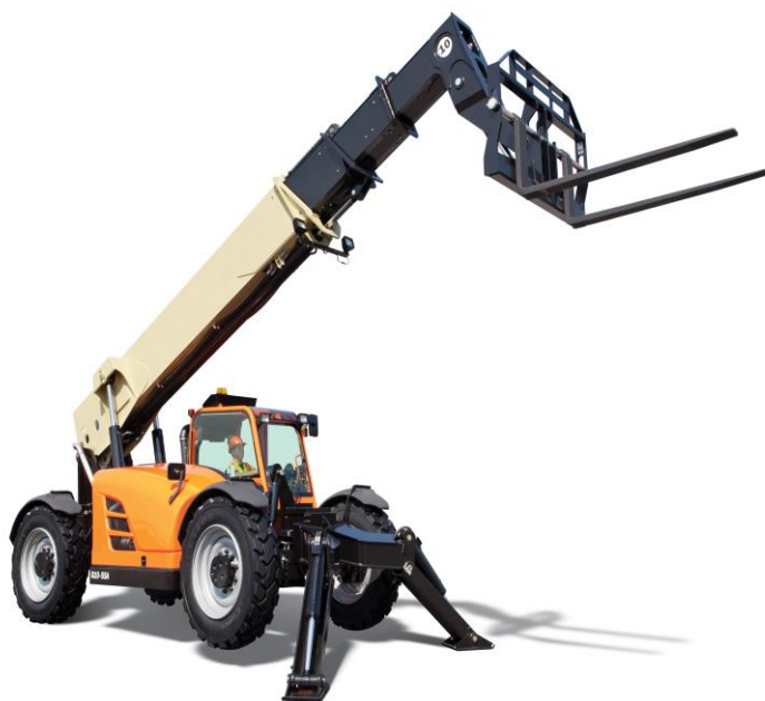
Fig. 14a-Carrello semovente a braccio telescopico fisso
