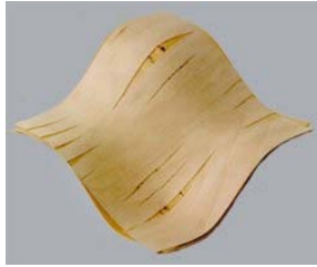
Figura 2.3: Parte in legno ottenuta tramite laminazione classica Fonte: [ http://www.reholz.de ]
