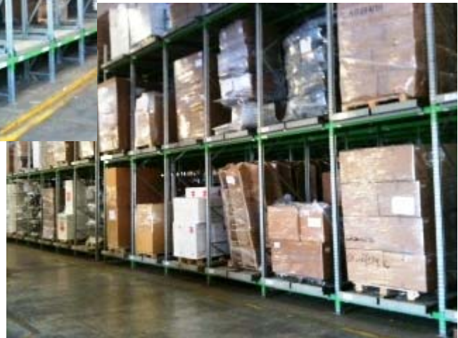
Figura 4.14 : Scaffalatura “a gravità” (uscita canali) in OMP
