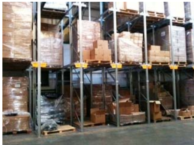
Figura 4.10 : Scaffalatura “drive-in” in OMP
