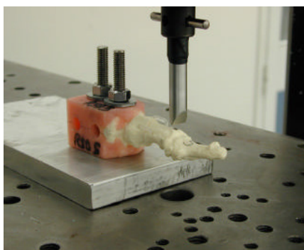
Figura 3.11 Applicazione del carico
