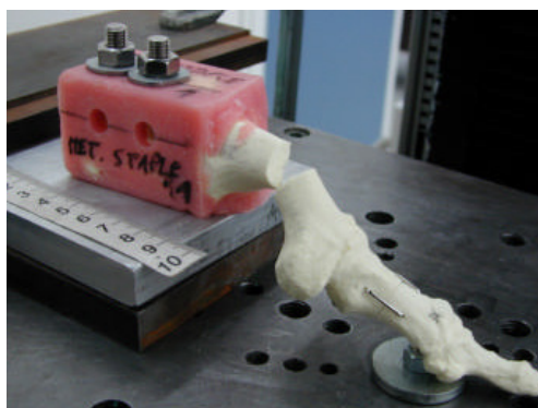
Figura 3.7 Prova di carico dall'alto per cambra metallica; posizione della rottura
